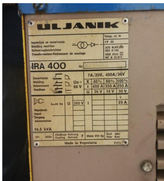
Slika 35. Karakteristike aparata za zavarivanje
