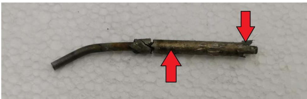
Slika 46. Vanjski sloj elektrode R 29/9 nakon zavarivanja (ljuštenje i izgorjeni dijelovi)
