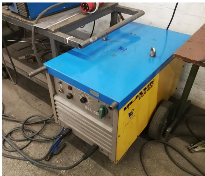
Slika 34. Uređaj za zavarivanje ULJANIK IRA 400
