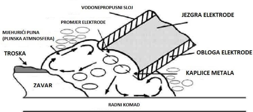
Slika 4. Shematski prikaz električnog luka pri mokrom podvodnom zavarivanju [3]
