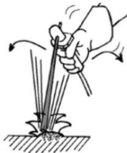
Slika 18. Zavarivanje tehnikom njihanja elektrode [14]
