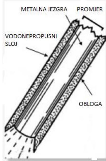
Slika 14. Shema elektrode [8]
