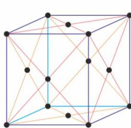
Slika 17. Prikaz plošno centrirane kubične strukture [13]
