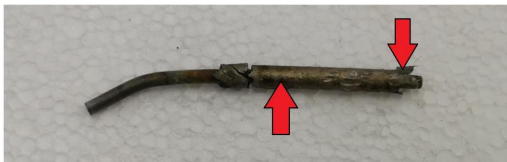
Slika 46. Vanjski sloj elektrode R 29/9 nakon zavarivanja (ljuštenje i izgoreni dijelovi)
