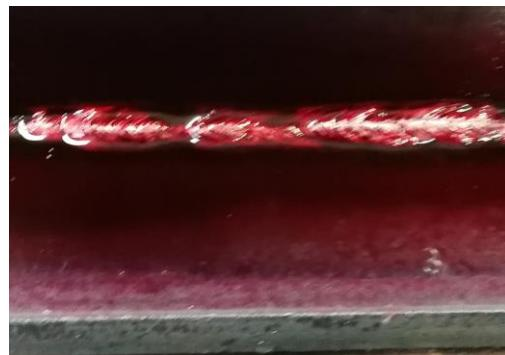
Slika 53. Penetrant na kontrolnom zavaru
