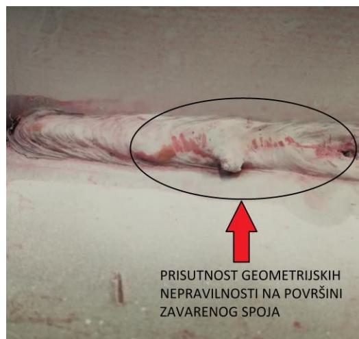
Slika 54. Rezultati penetracijske analize na zavaru 1
