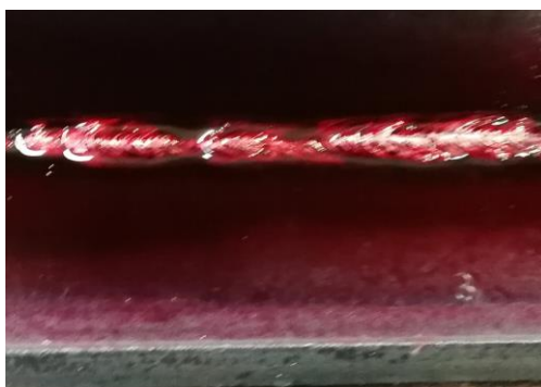
Slika 53. Penetrant na kontrolnom zavaru
