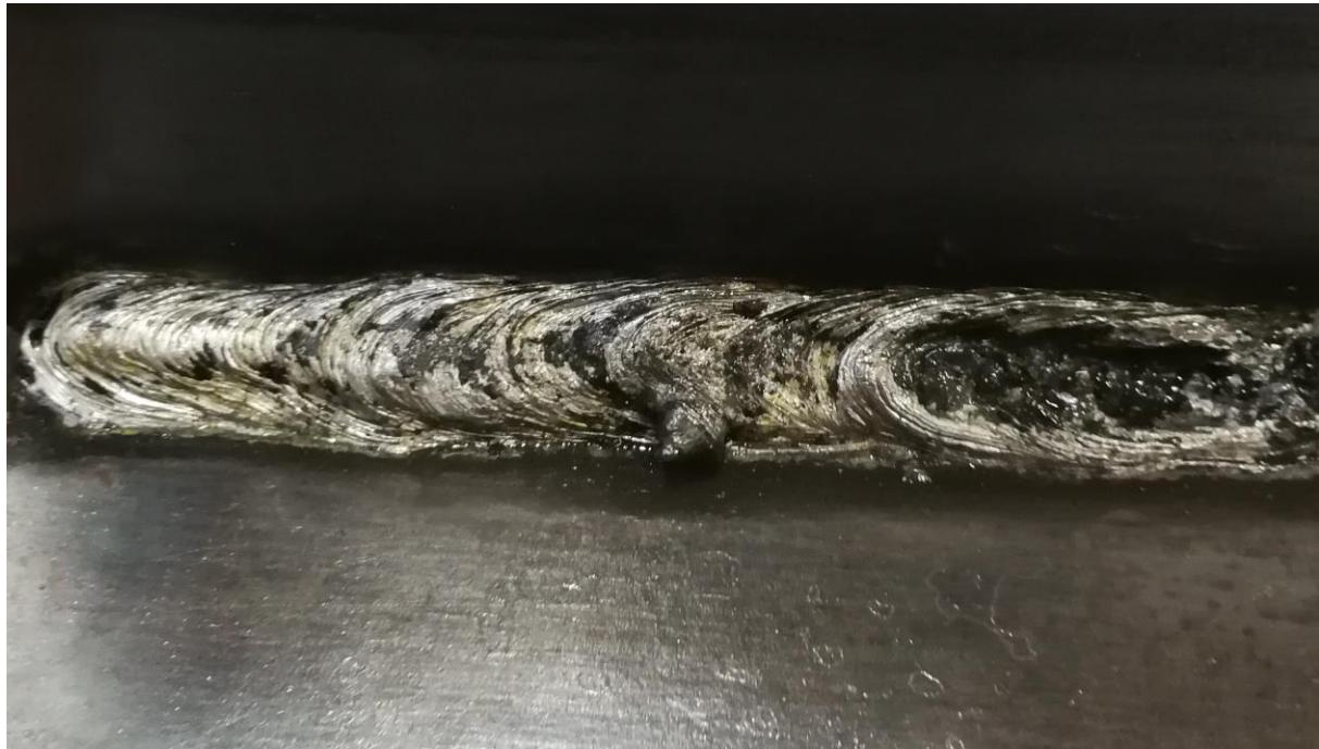
Slika 43. Zavar izveden s elektrodom R29/9
