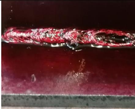
Slika 51. Penetrant na zavaru 1
