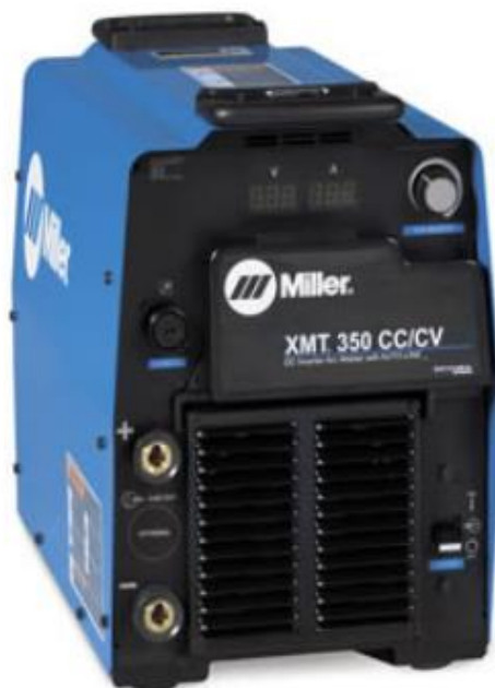
Slika 10. Izvor električne energije za podvodno zavarivanje [25]
