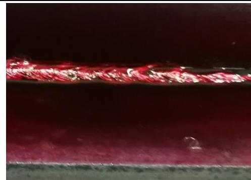
Slika 52. Penetrant na zavaru 2
