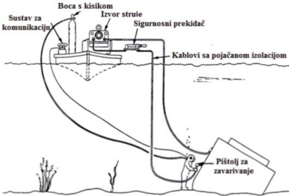
Slika 9. Oprema za mokro podvodno zavarivanje [24]
