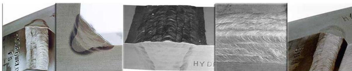
Slika 26. Zavari napravljeni elektrodom HYDROWELD FS [16]
