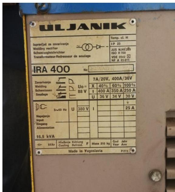
Slika 35. Karakteristike aparata za zavarivanje
