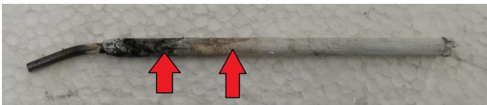
Slika 47. Vanjski sloj elektrode R 19/9 nakon zavarivanja (ljuštenje i izgorjeni dijelovi)
