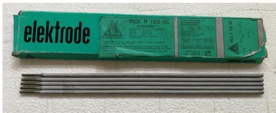
Slika 36. Elektroda R 19/9 prije bojanja
