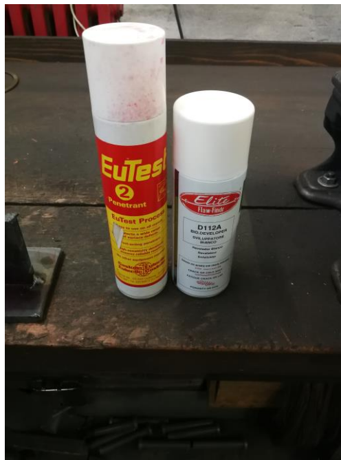
Slika 50. Penetrant (lijevo) i razvijajč (desno) korišteni u eksperimentu
