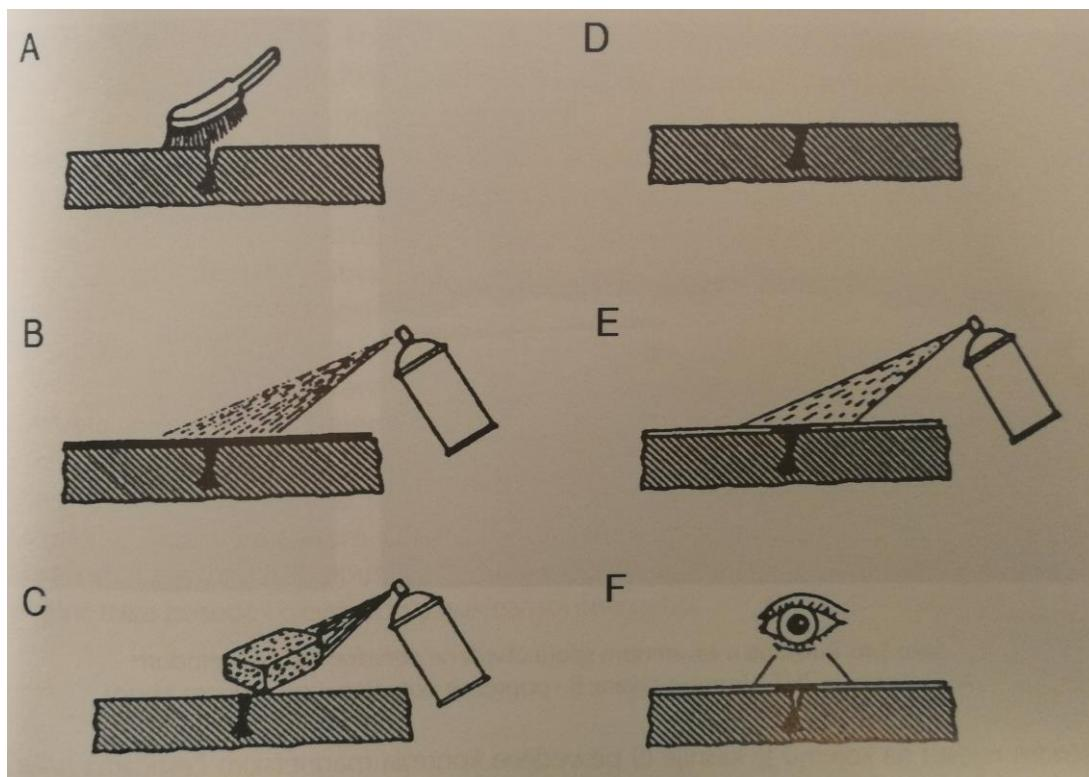
Slika 49. Postupak primjene penetrantke metode ispitivanja [10]
