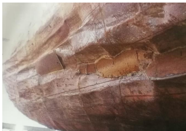
Slika 31. Popravci na pramcu broda [15]
