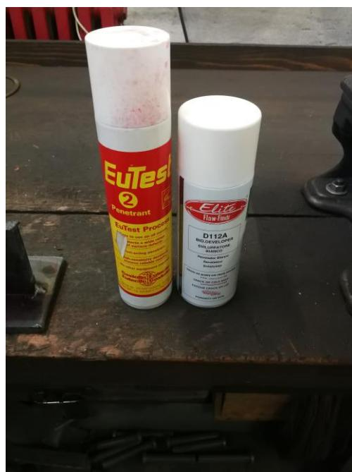
Slika 50. Penetrant (lijevo) i razvijač (desno) korišteni u eksperimentu
