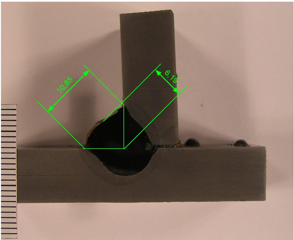
Slika 59. Geometrija zavara na presjeku
