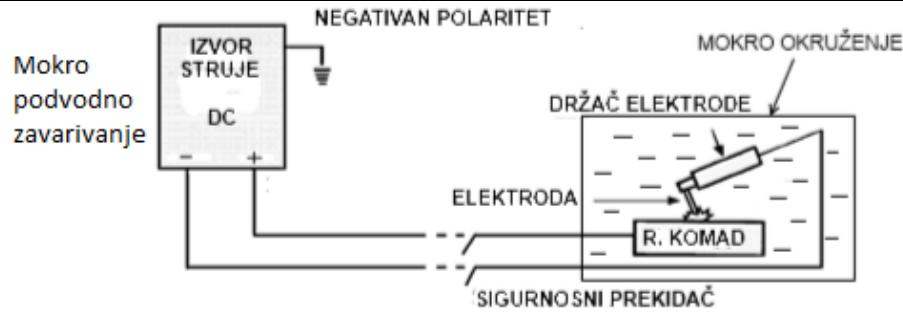
Slika 3. Shematski prikaz mokrog podvodnog zavarivanja [3]
