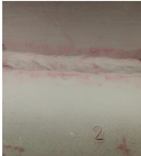
Slika 55. Rezultati penetracijske analize na zavaru 2
