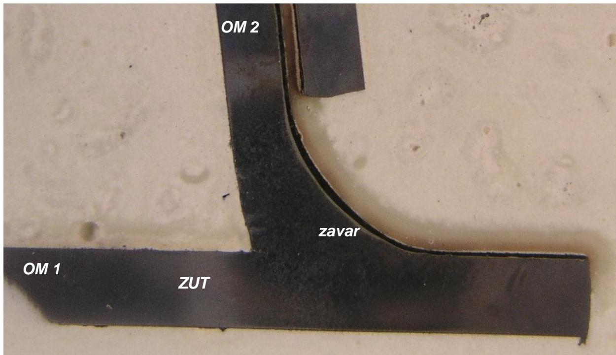
**Slika 53. Segment šasije PODNICA uzorak 4: makrostruktura s mjestima analize mikrostrukture**
