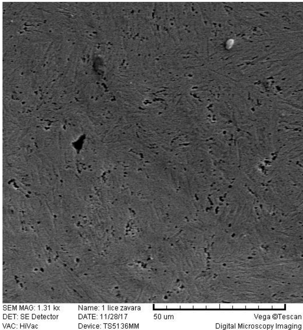
**Slika 61. Segment šasije PODNICA uzorak 4: mikrostruktura ispod površine zavara, SEM, sitan porozitet**
