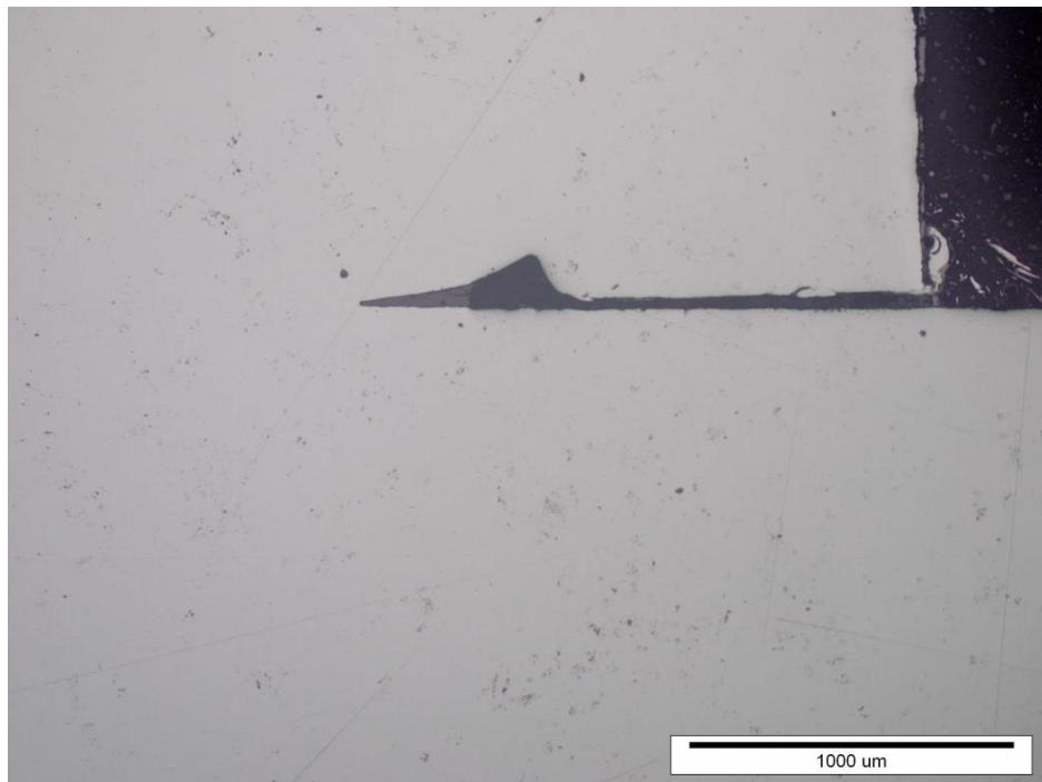
Slika 67. Segment šasije PODNICA uzorak 5: mikrostruktura na poziciji ZAVAR,
