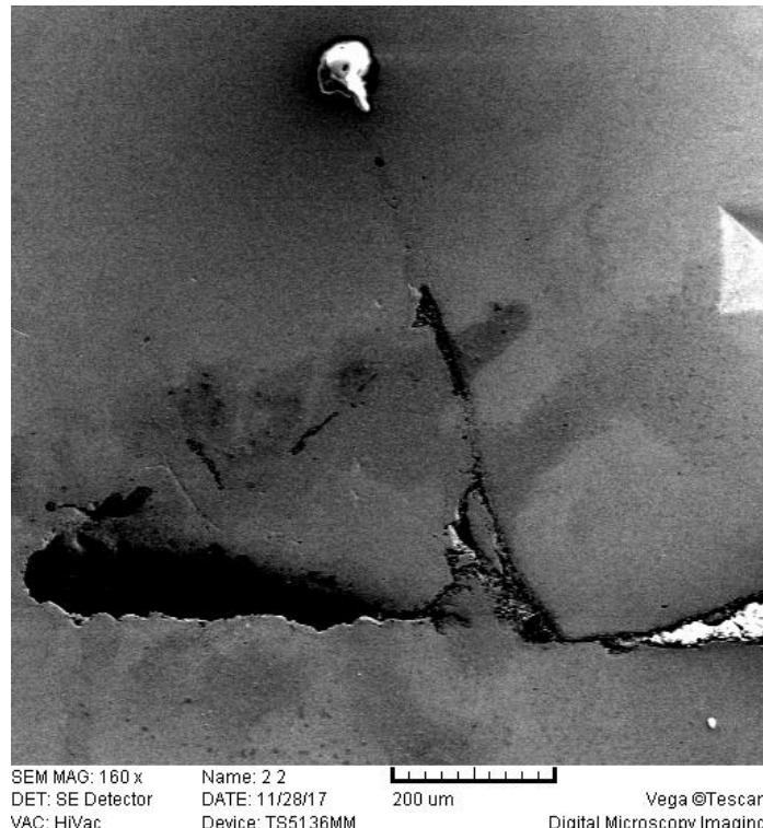
Slika 37. Segment šasije FIREWALL uzorak 2: detalj zavara, SEM
