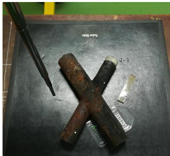
Slika 17. Segment šasije FIREWALL pripremljen za radiografsku analizu
