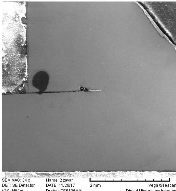
Slika 70. Segment šasije PODNICA uzorak 5: zavar, SEM, neprotaljenost
