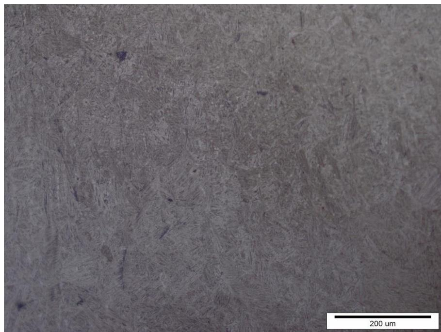
**Slika 58. Segment šasije PODNICA uzorak 4: mikrostruktura na poziciji ZAVAR, gruboznata dendritna mikrostruktura**
