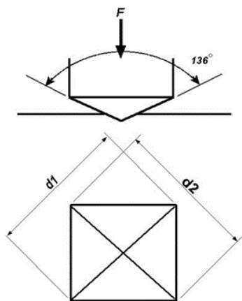
Slika 7. Vršni kut i otisak penetratora Vickersovog tvrdomjera [10]
