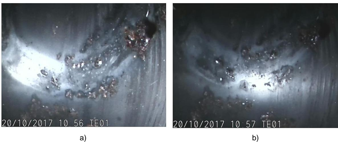
**Slika 15. Segment šasije FIREWALL: stanje unutrašnje površine cijevi na mjestu zavara**
