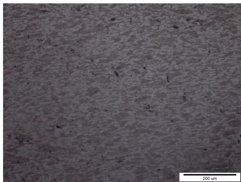
**Slika 54. Segment šasije PODNICA uzorak 4: mikrostruktura osnovnog materijala na poziciji OM1, usmjereni feritno-perlitna mikrostruktura**
