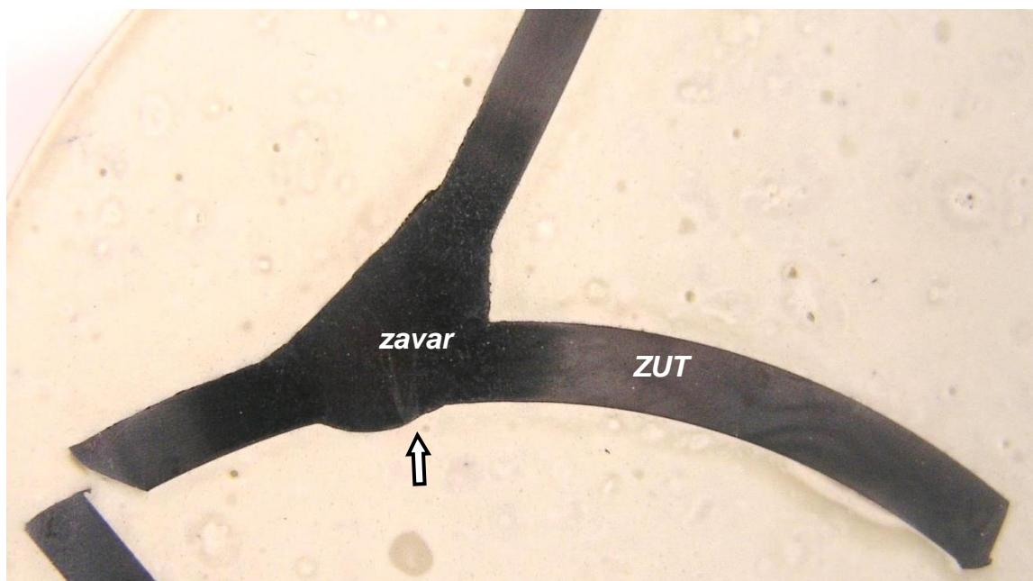
**Slika 40. Segment šasije FIREWALL uzorak 3: makrostruktura s mjestima analize mikrostrukture**
