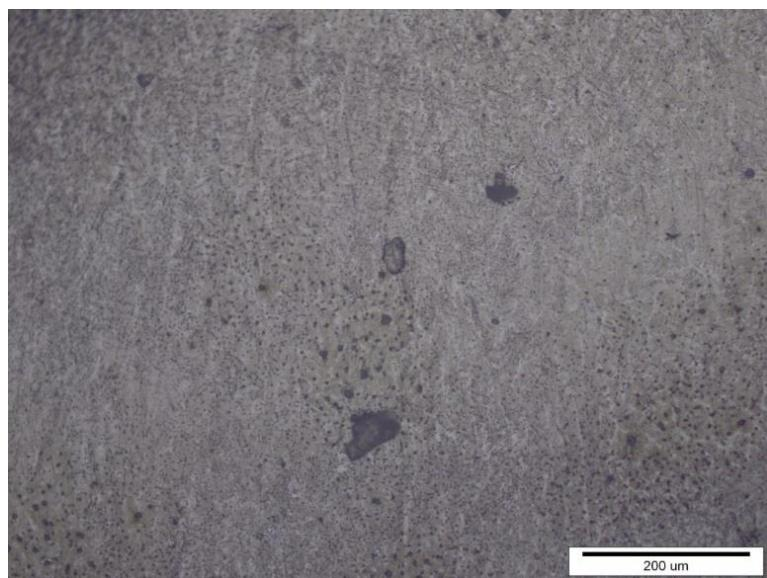
Slika 85. Segment šasije PODNICA uzorak 7: mikrostruktura na poziciji ZAVAR, porozitet
