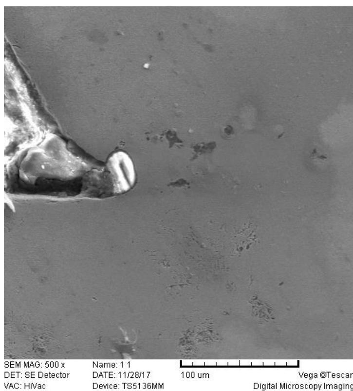
Slika 28. Segment šasije FIREWALL uzorak 1: detalj zavara, SEM, porozitet
