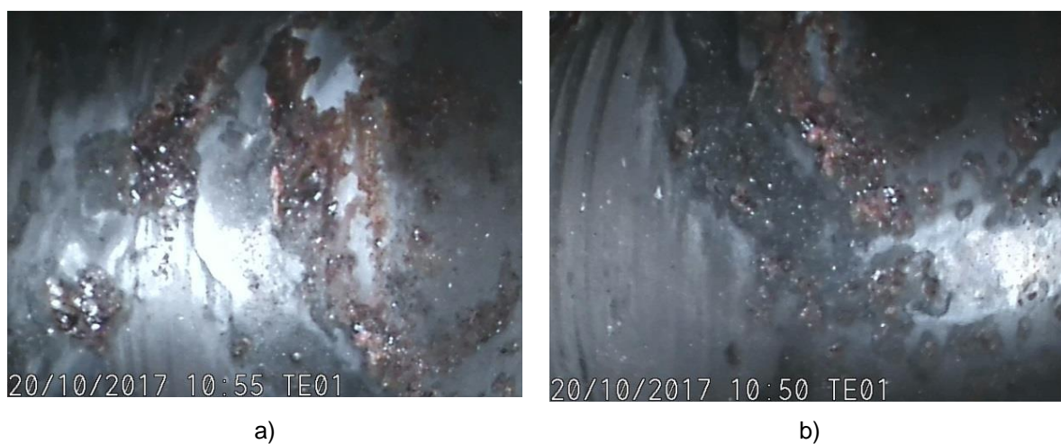
Slika 14. Segment šasije FIREWALL: stanje unutrašnje površine cijevi gdje se vidi osnovni materijal.
