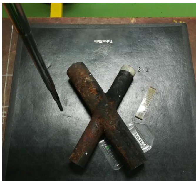
Slika 17. Segment šasije FIREWALL pripremljen za radiografsku analizu
