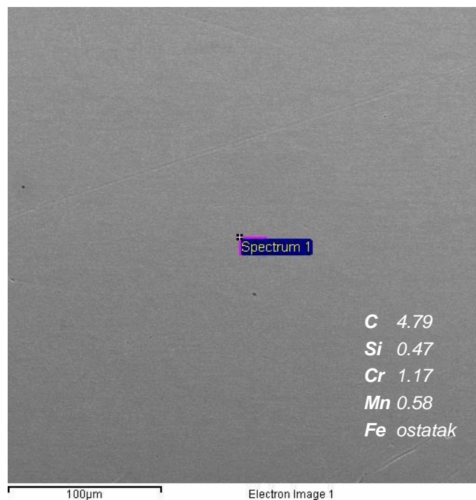
Slika 29. Segment šasijske FIREWALL uzorak 1: mjesto i rezultati EDS analize, OM1
