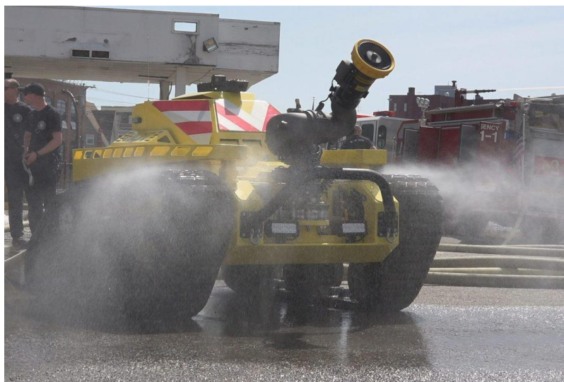
Slika 8. Sustav hlađenja Thermita
