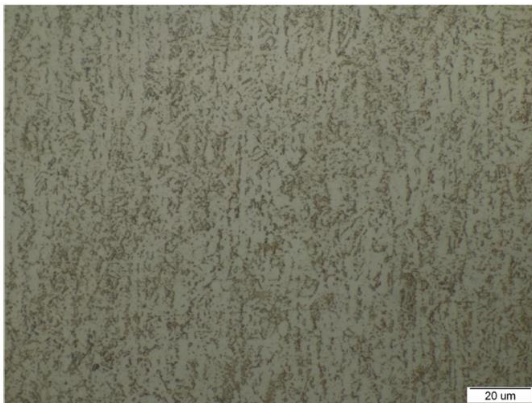
Slika 38. Jezgra uzorka Ti6Al4V legure na svjetlosnom mikroskopu pri povećanju 1000:1
