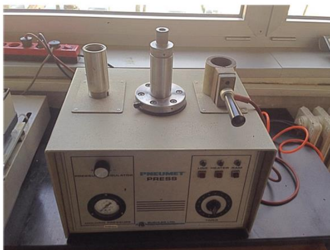
Slika 32. Uređaj za učvršćivanje uzorka (zalijevanje) u polimernoj masi (topli postupak)
