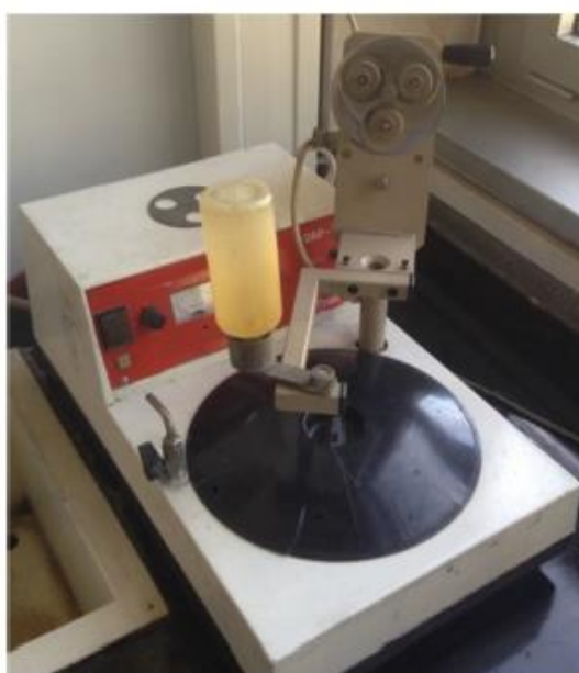
Slika 33. Uređaj za pripremu metalografskih uzoraka poliranjem
