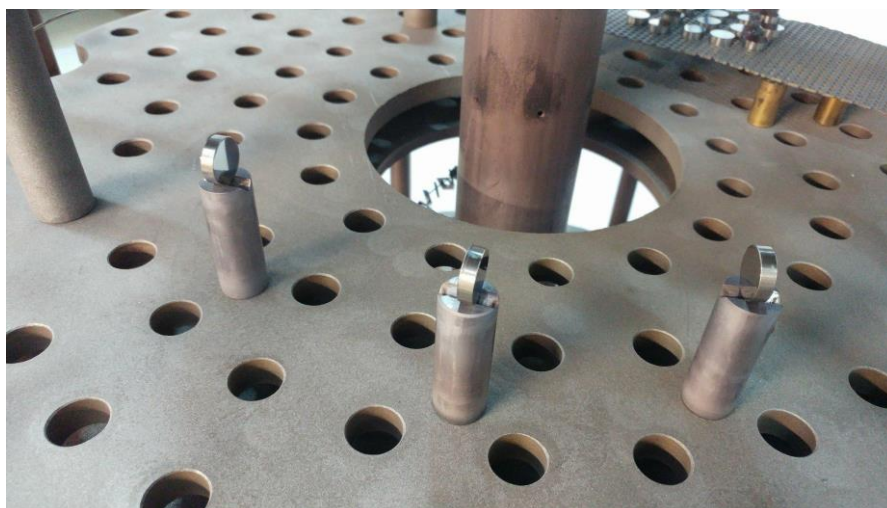
Slika 30. Položaj uzoraka za nitriranje u plazmi
