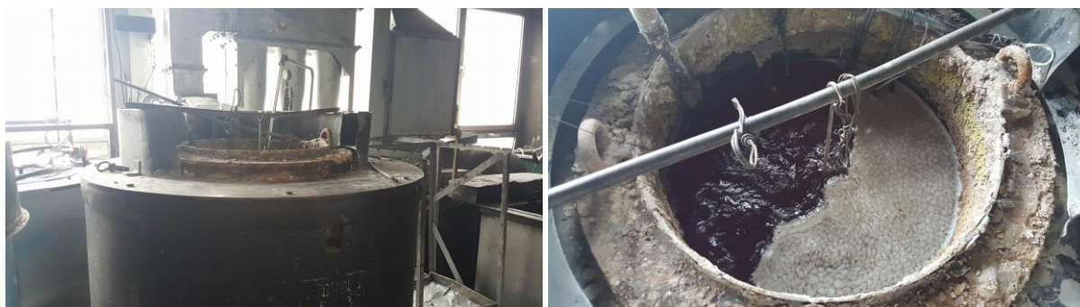
Slika 31. Solna kupka za nitriranje postupkom TENIFER
