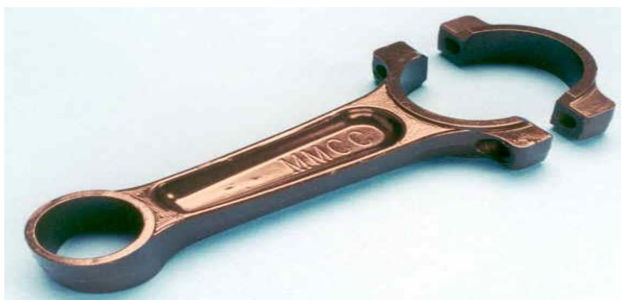
Slika 2.14 Klipnjača s Al matricom ojačana Al 2 O 3 česticama[3]
