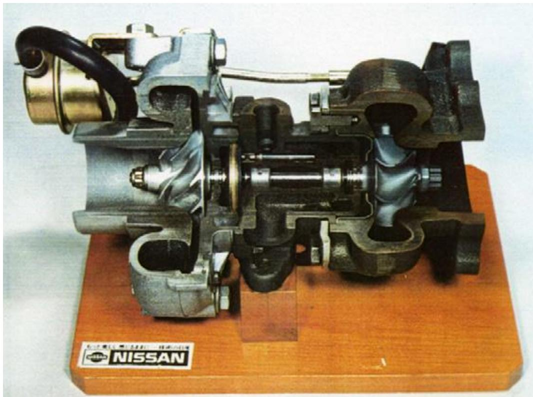
Slika 3.5 Nissanov turbopunjač od silicij nitrida [12]
