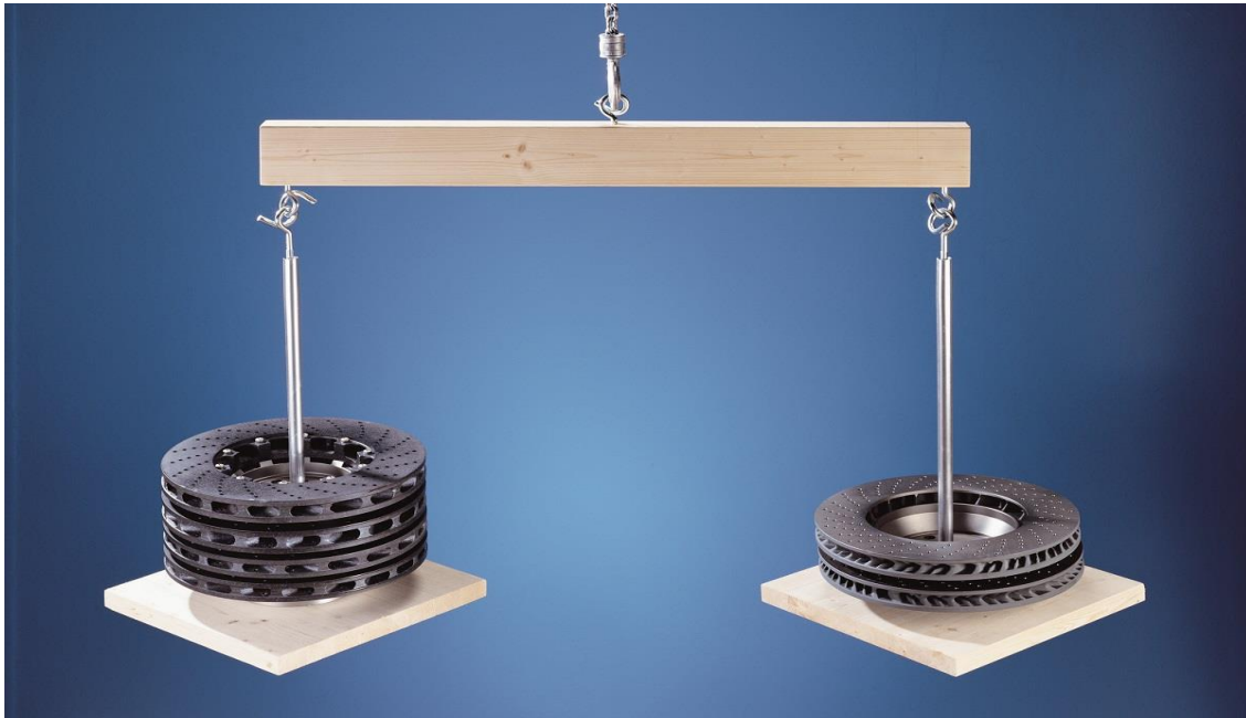
Slika 3.13 Odnos mase keramičkog kompozitnog kočionog diska i mase diska od sivog lijeva [5]
