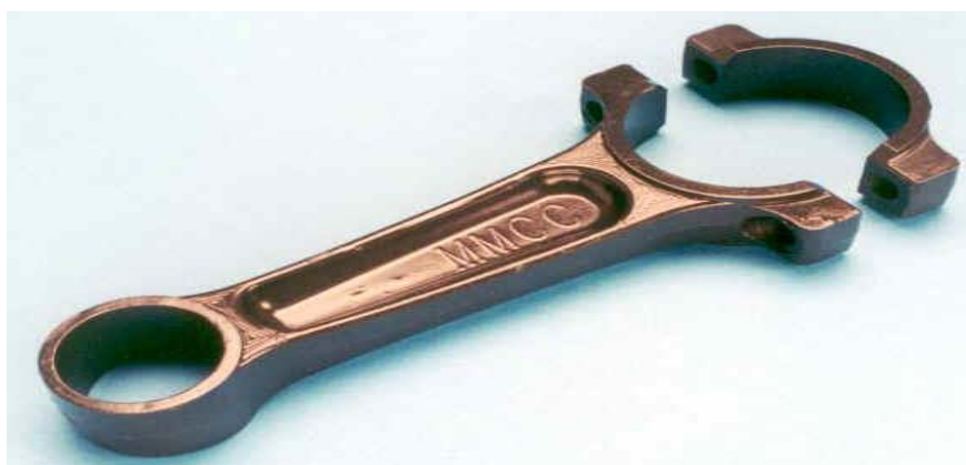
Slika 2.14 Klipnjača s Al matricom ojačana \text{Al}_2\text{O}_3 česticama[3]
