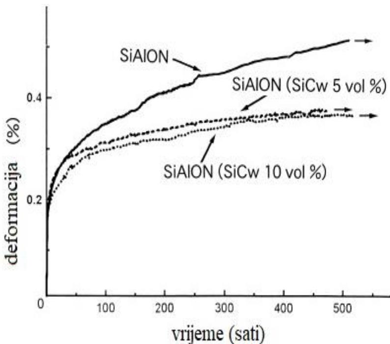
Slika 3.9 Dijagram puzanja monolitne keramike i keramičkog kompozita [13]
