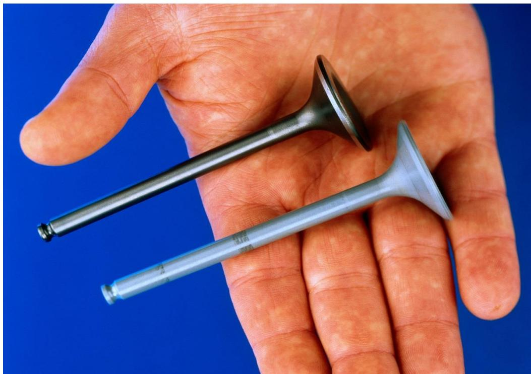
**Slika 3.1 Ventili u automobilskom motoru[5]**
