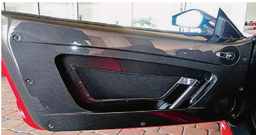
Slika 2.11 Paneli vrata plastomerne matrice ojačane ugljikovim vlaknima[1]
