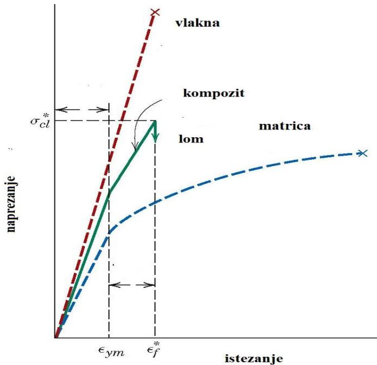
Slika 2.7 Dijagram naprezanje-istezanje vlaknima ojačanog kompozita [3]
