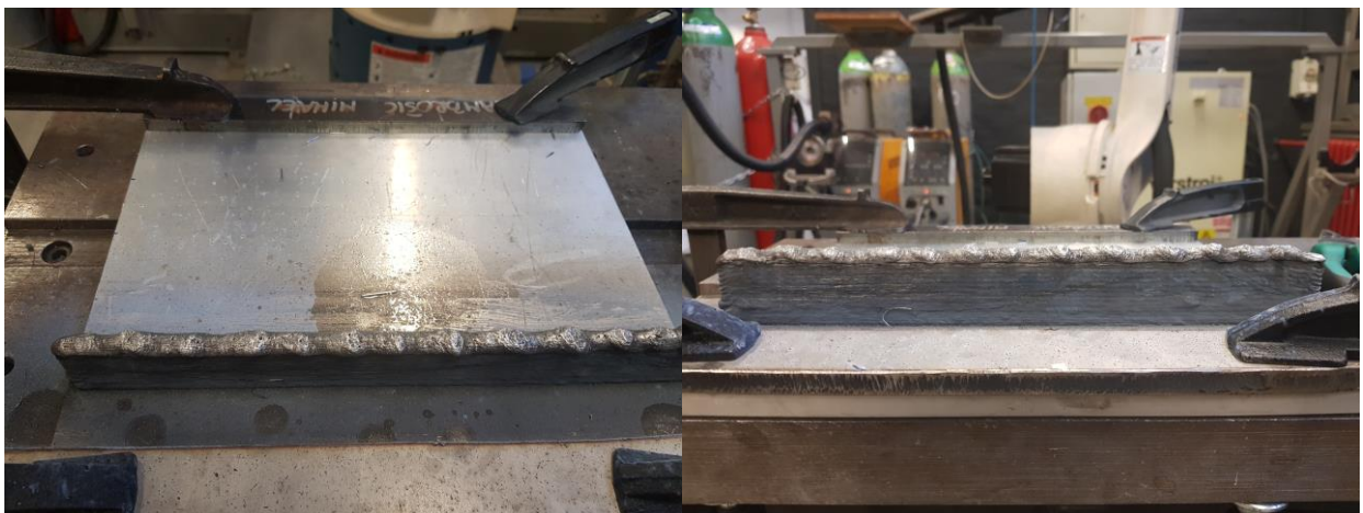
Slika 32. Novi problemi uzrokovani oštećenjem bužira
