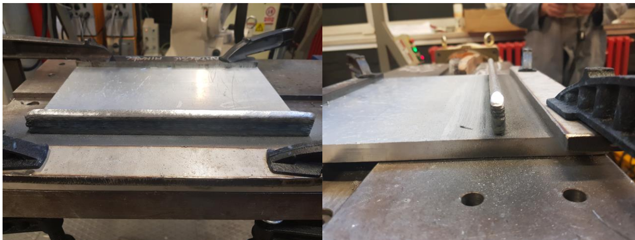
Slika 31. Tijek izrade prvog zida – pogled sprijeda i s boka
