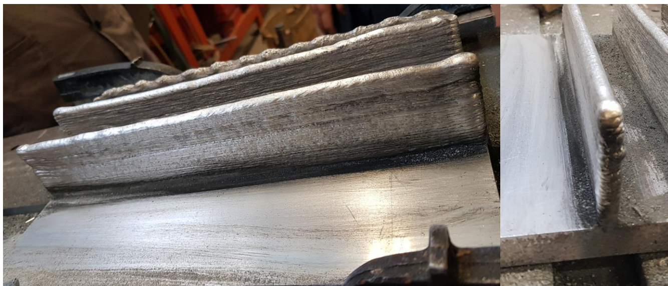
Slika 36. Izrađen zid 2. – pogled sprijeda i s boka
