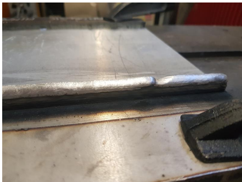
Slika 30. Nepravilnost zavora pri izradi zida 1
