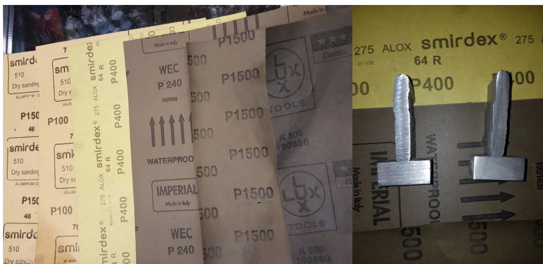
Slika 39. Brusni papiri različite zrnatosti i ručno izbrušeni uzorak 1.
