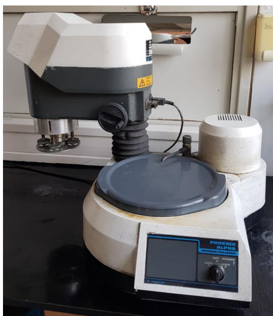
Slika 40. Uređaj za fino poliranje – Phoenix Alpha Grinder Polisher
