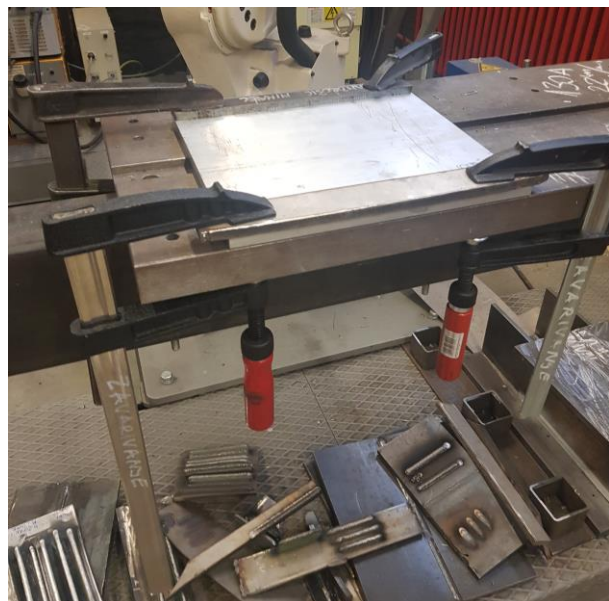
Slika 27. Pozicioniranje i stezanje osnovne ploče
