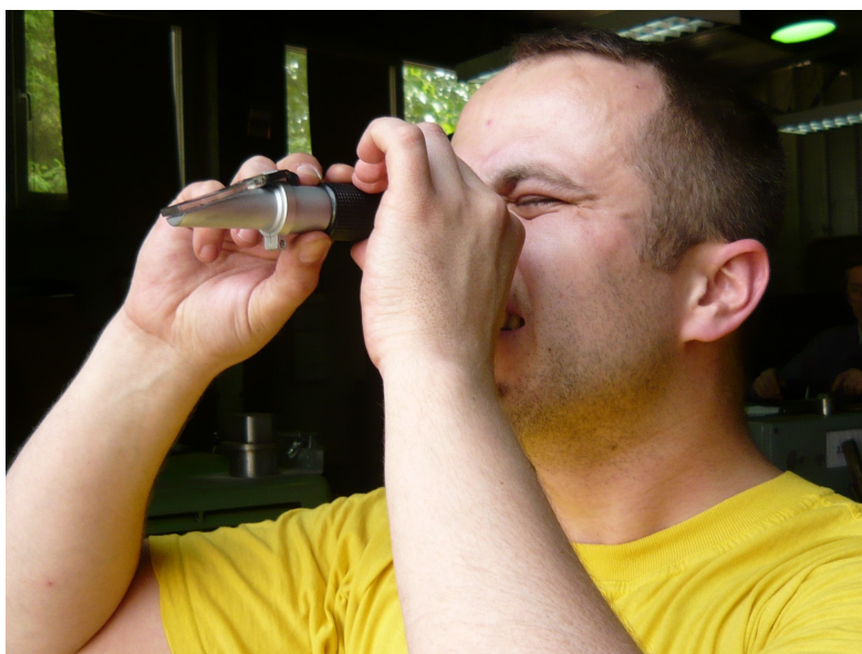
Slika 36: Očitavanje skale na okularu refraktometra
