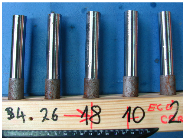
Slika 48: Uzorci nakon 5.30 h u vlažnoj komori
