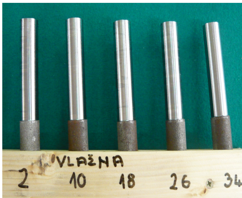
Slika 45: Uzorci pripremljeni za ispitivanje u vlažnoj komori
