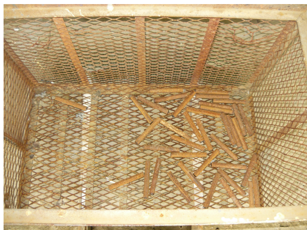
Slika 30: Uzorci pripremljeni za pjeskarenje
