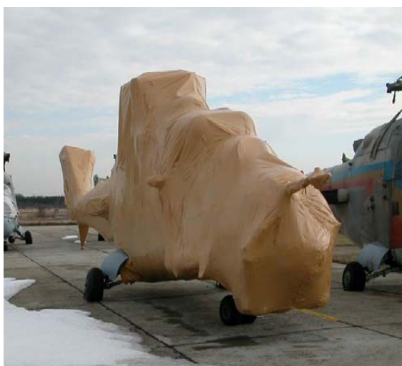
Slika 21: Primjena inhibitora korozije za zaštitu borbenih letjelica[12]
