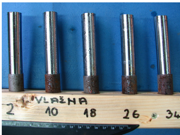
Slika 47: Uzorci nakon 5.30 h u vlažnoj komori
