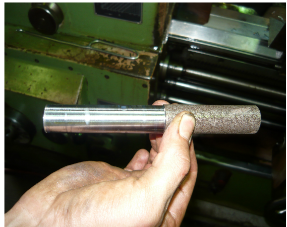
Slika 43: Obrađeni uzorak nakon vađenja iz čeljusti stroja
