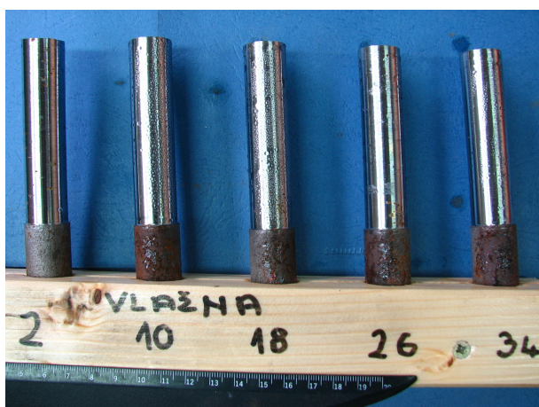
Slika 47: Uzorci nakon 5.30 h u vlažnoj komori
