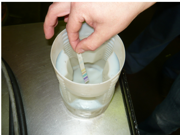
Slika 32: Uranjanje papirića u vodu
