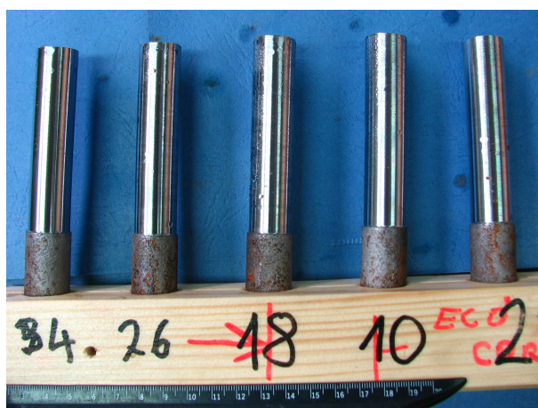
Slika 48: Uzorci nakon 5.30 h u vlažnoj komori
