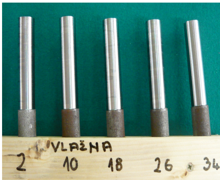
Slika 45: Uzorci pripremljeni za ispitivanje u vlažnoj komori
