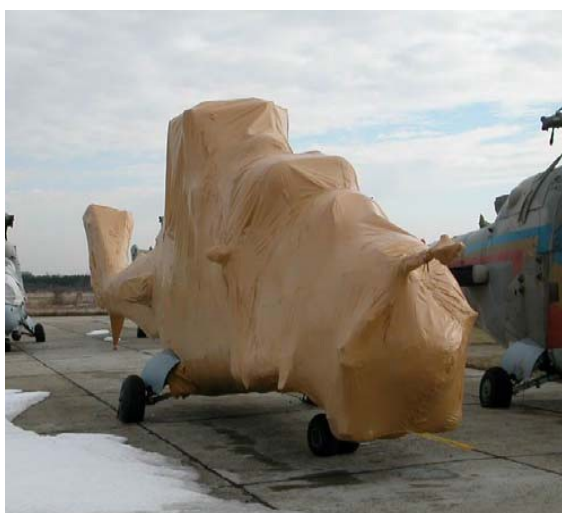
Slika 21: Primjena inhibitora korozije za zaštitu borbenih letjelica[12]
