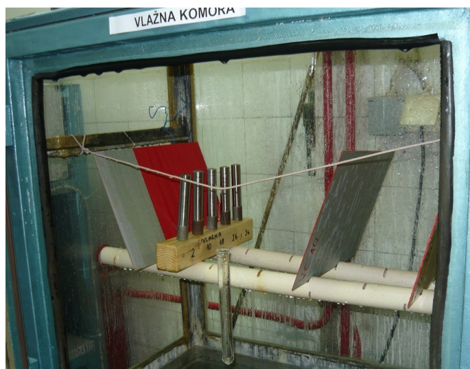
Slika 46: Pozicija uzoraka u vlažnoj komori
