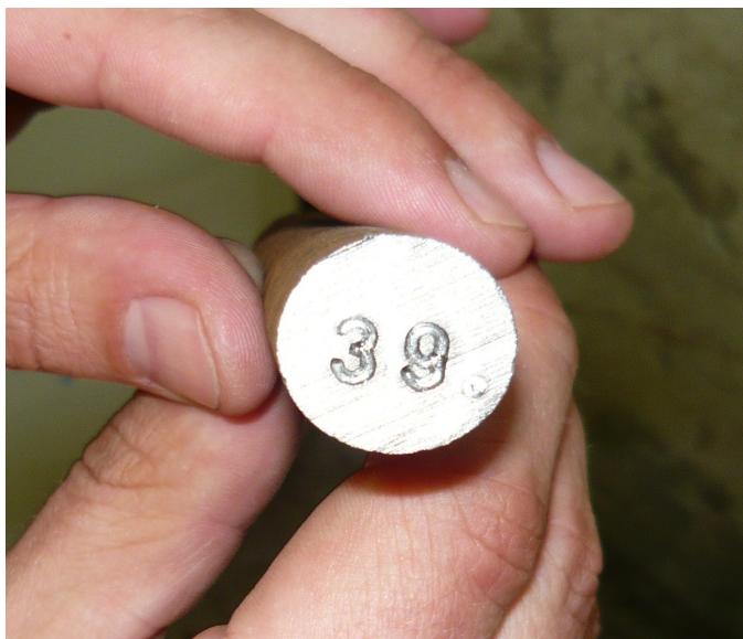
Slika 31: Prikaz utisnutog broja na bočnu stranu uzorka
