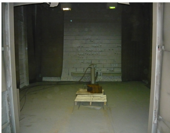
Slika 29: Komora za pjeskarenje
