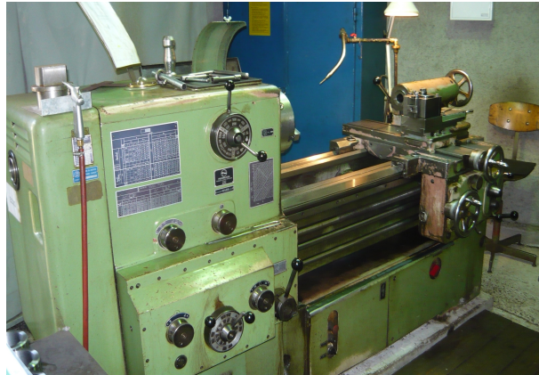
Slika 38: Tokarilica Prvomajska sistem Niles
