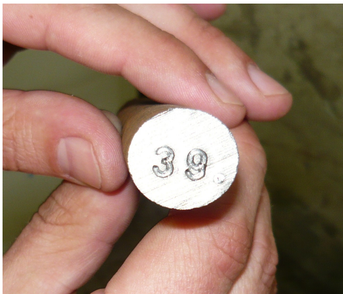
Slika 31: Prikaz utisnutog broja na bočnu stranu uzorka
