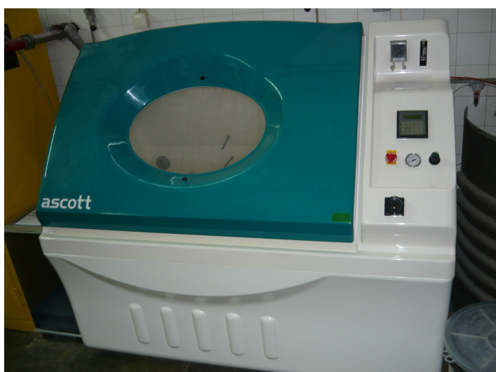
Slika 51: Slana komora Ascott
