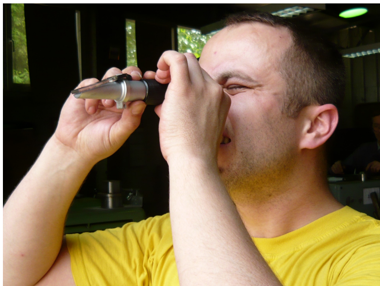
Slika 36: Očitavanje skale na okularu refraktometra
