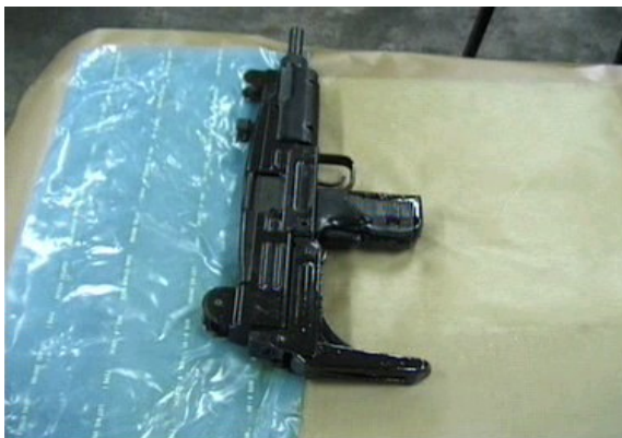
Slika 19: Prikaz pješačkog oružja i omota sa hlapivim inhibitorom korozije[12]
