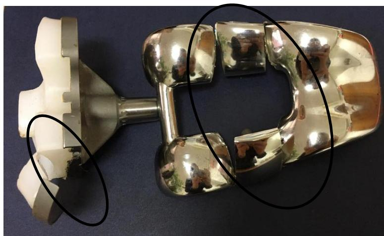
Slika 17. Uzorak nakon rezanja uz prikazana mesta rezanja
