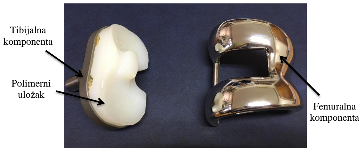
Slika 16. Uzorak prije rezanja. Na slici su označeni materijali pojedinih dijelova.
