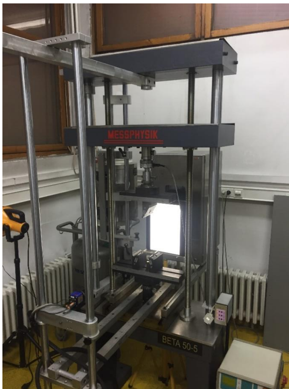
Slika 43. Kidalica MESSPHYSIK BETA 50-5 u laboratoriju za eksperimentalnu mehaniku
