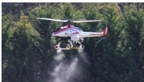
Slika 5.1. Yamaha R-MAX VTOL u uporabi [9]
