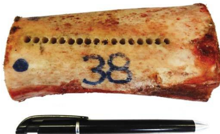
Slika 4.6. Ispitni uzorak nakon bušenja [1]
