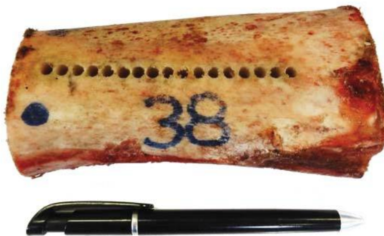
Slika 4.6. Ispitni uzorak nakon bušenja [1]
