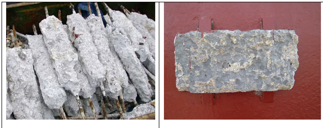
Slika 2. Primjeri istrošenih anoda [6]
