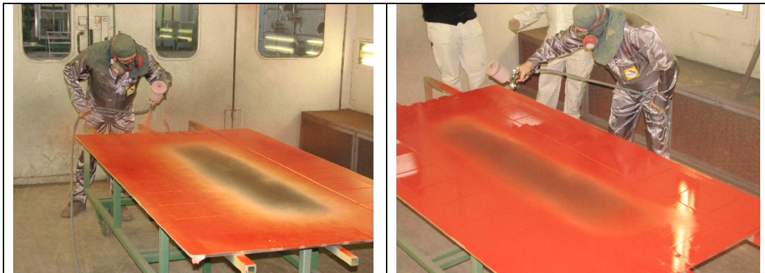
Slika 20. Nanošenje završnog vodorazrjedivog sloja [29]
