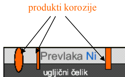
Slika 5. Katodna prevlaka nikla na čeliku [10]
