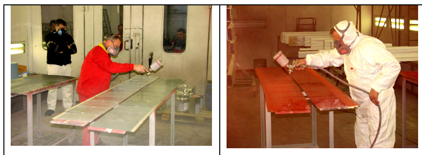
Slika 18. Nanošenje premaza na bazi otapala [29]
