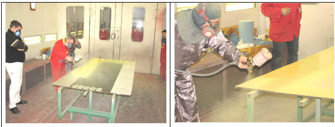
Slika 19. Nanošenje vodorazrjeđivog temelja [29]
