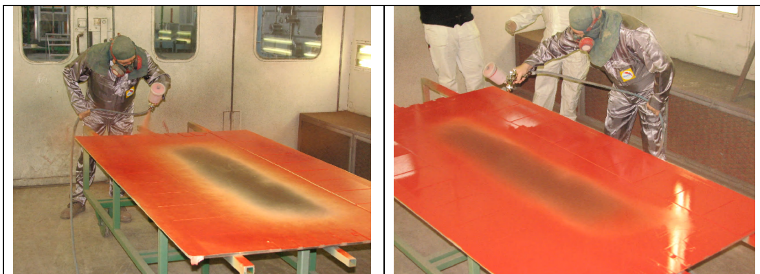
Slika 20. Nanošenje završnog vodorazrjedivog sloja [29]
