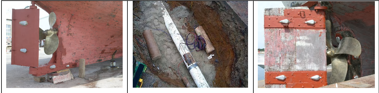
Slika 3. Primjeri katodne zaštite primjenom protektora [6]
