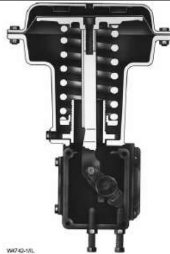
Slika 26. Membranski pneumatski motor [2]
