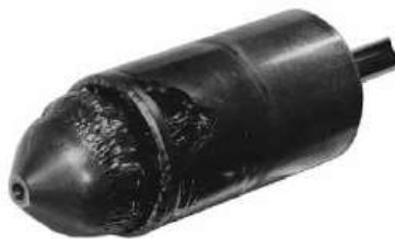
Slika 29. Karakterističan izgled nakon uništenja flashingom [2]
