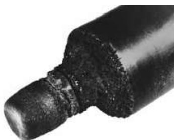
Slika 28. Karakterističan izgled nakon uništenja flashingom[2]
