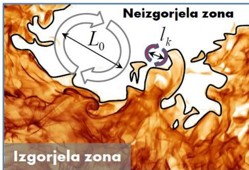
Slika 10. Izgorjela i neizgorjela zona u cilindru [3]
