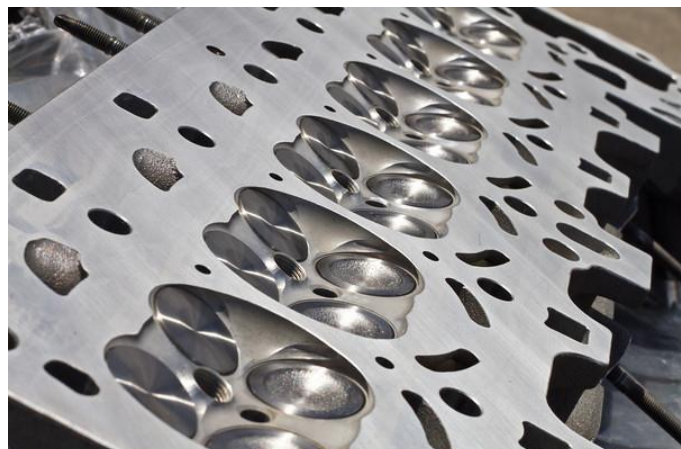
Slika 16. Klip i glava motora N55
