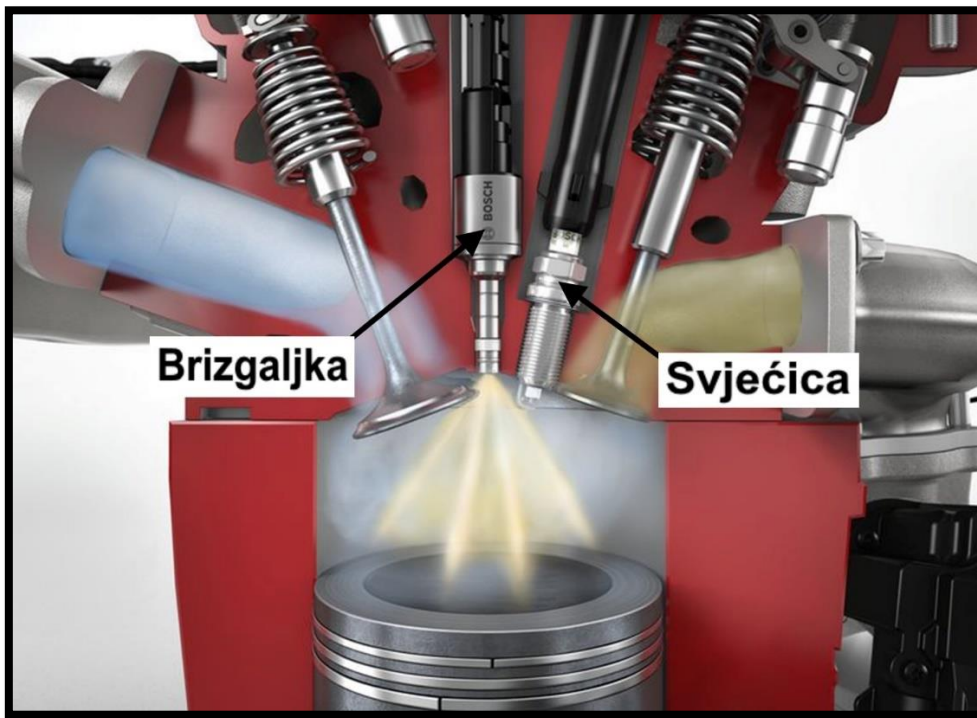
Slika 2. Direktno ubrizgavanje goriva u cilindar [10]
