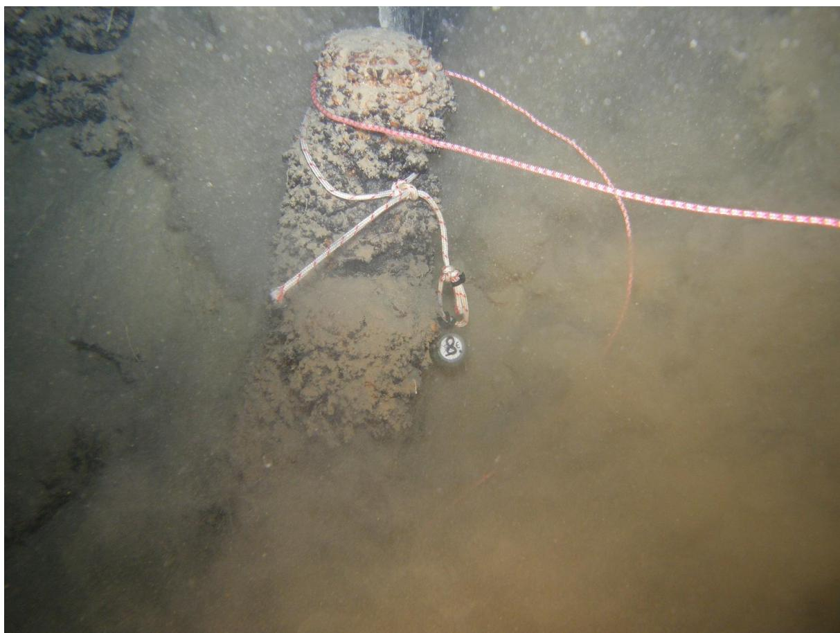
Slika 9. Data logger pričvršćem užetom za spilju
