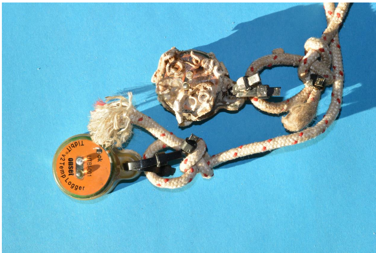
Slika 10. Data logger nakon vadenja iz spilje
