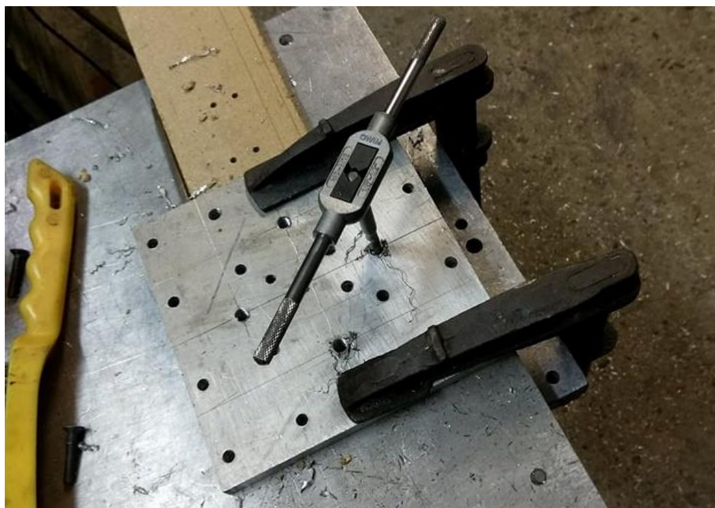
Slika 54. Praktični postav (urezivanje navoja)
