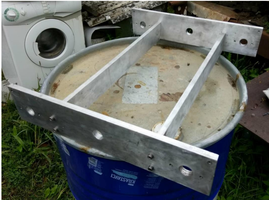
Slika 49. Praktični postav (postolje i X osi)
