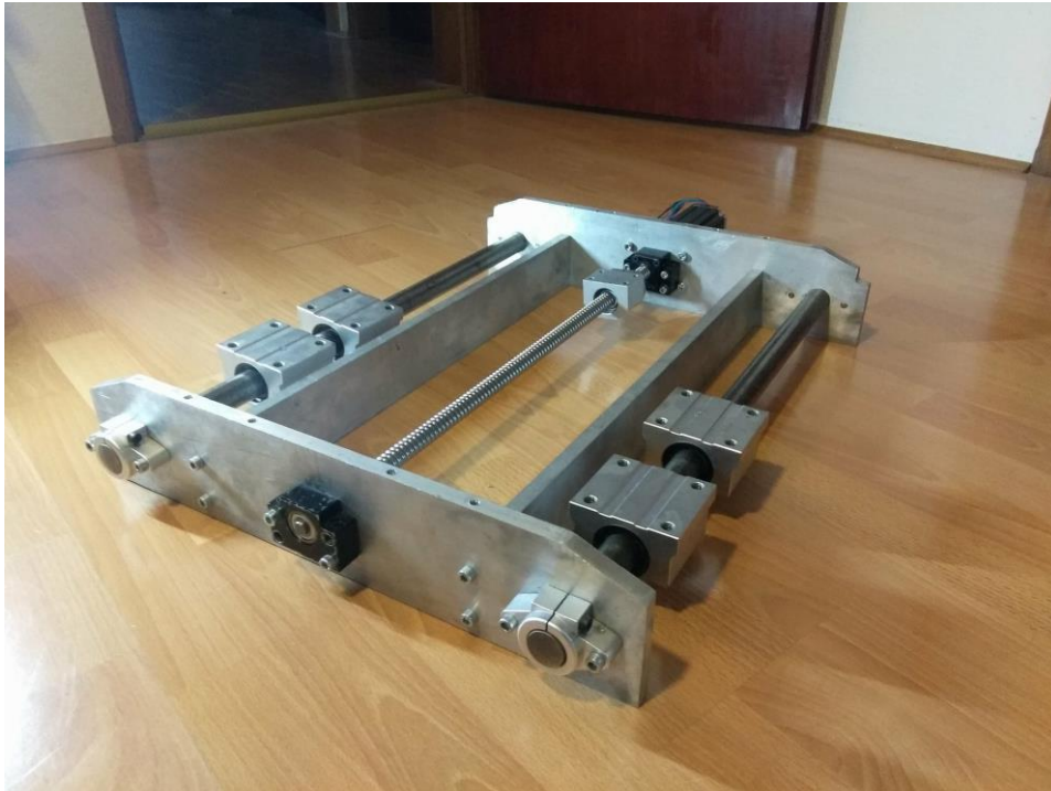
Slika 50. Praktični postav (postolje i X osi, gotovi sklop)
