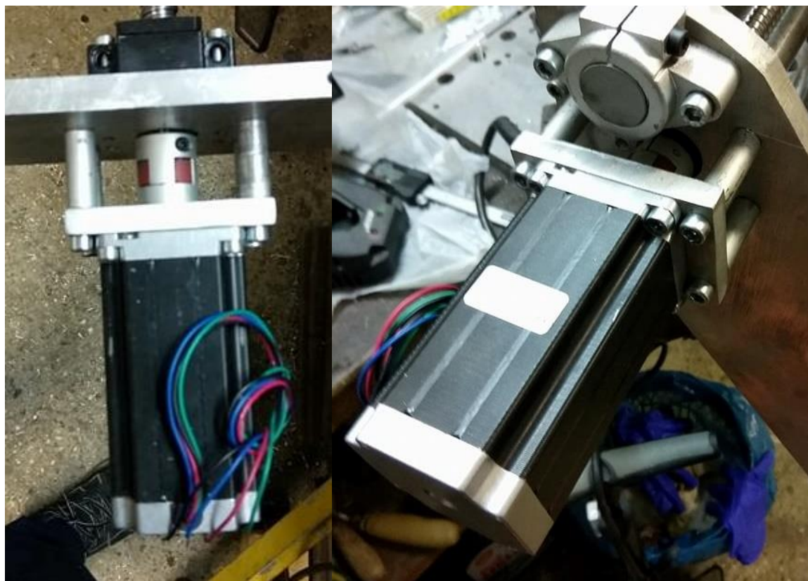
Slika 55. Praktični postav (montiranje motora, lijevo X os, desno Y os)
