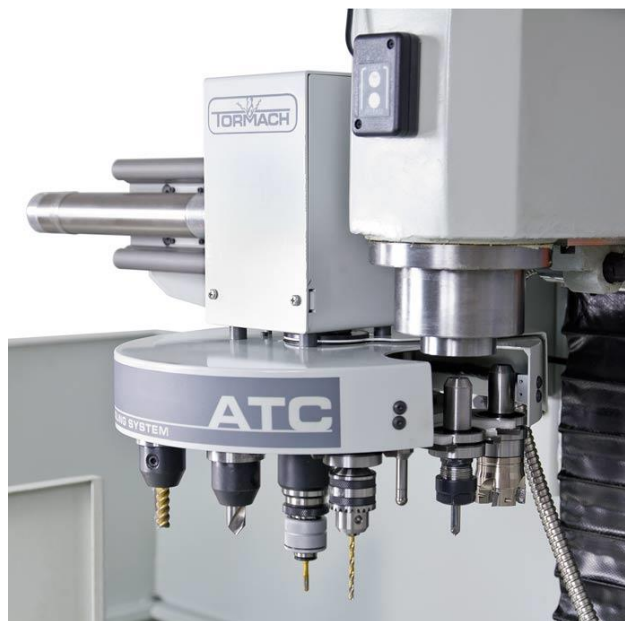
Slika 14. Sistem automatske promjene alata
