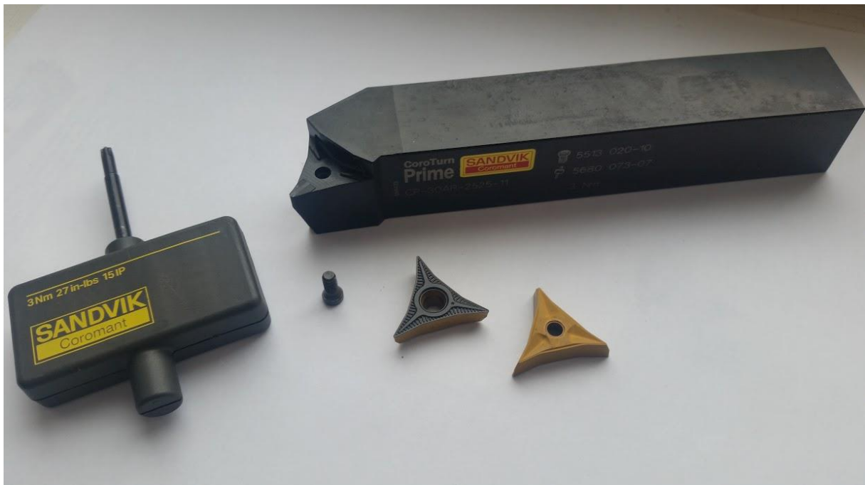
Slika 24. Držač alata, dvije pločice A- tipa, vijak i moment ključ
