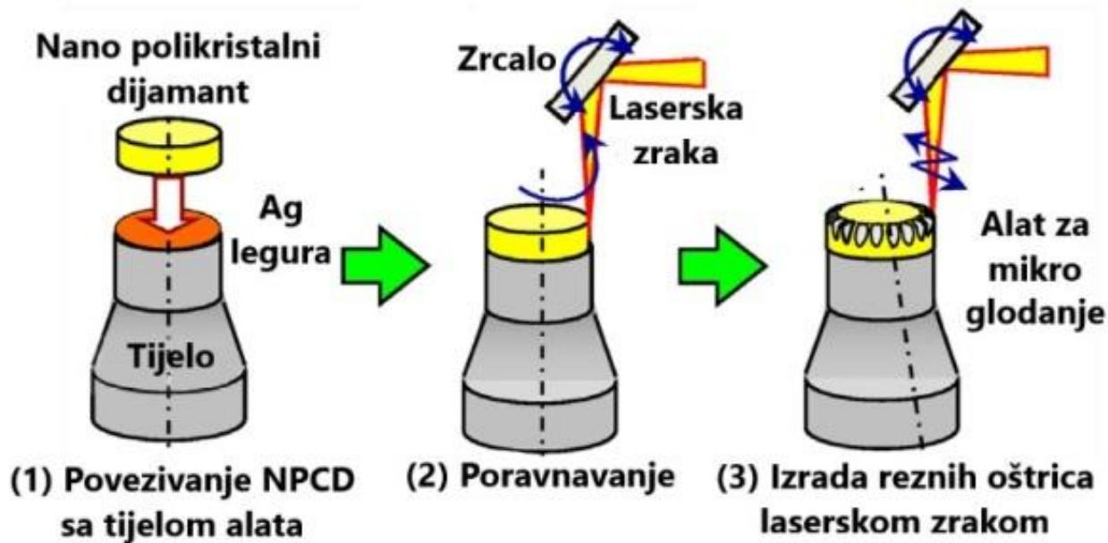
Slika 10. Postupak izrade mikro glodala laserom [13]
