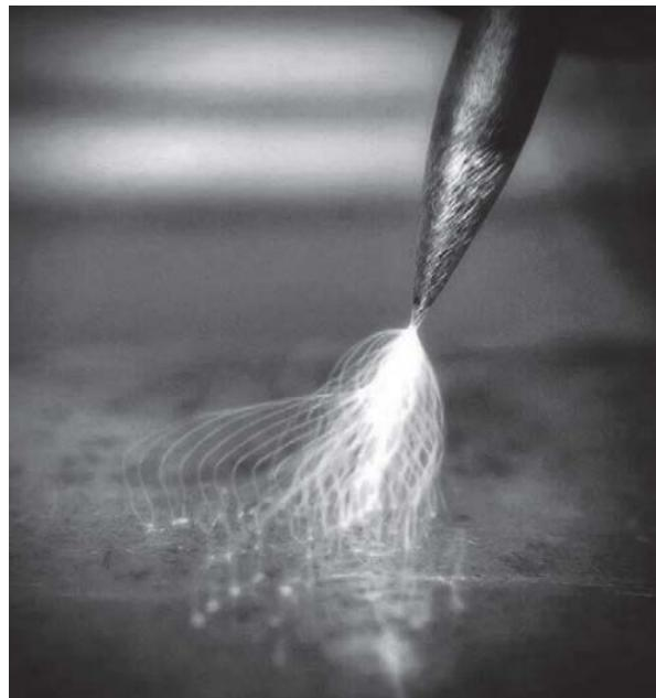
Slika 13. Uspostava električnog luka visokofrekventnim generatorom [14]
