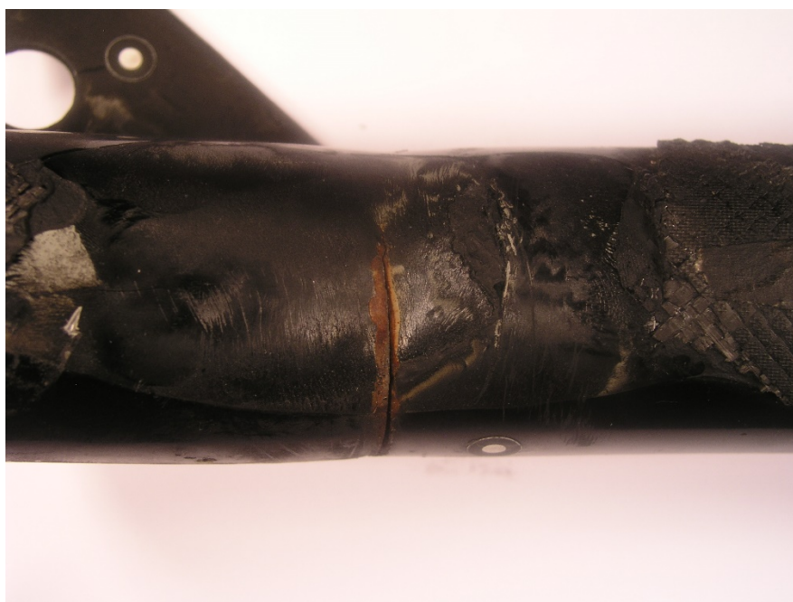
Slika 10. Pukotina na uzorku
