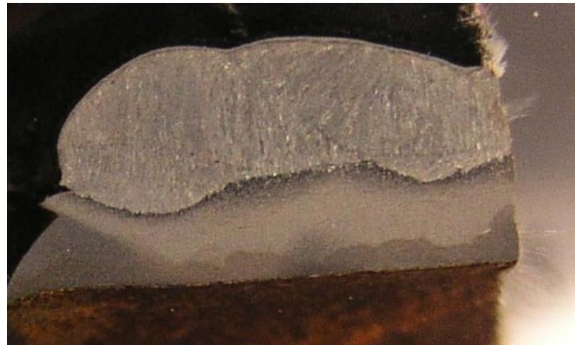
Slika 29. Presjek zavara i ZUT-a
