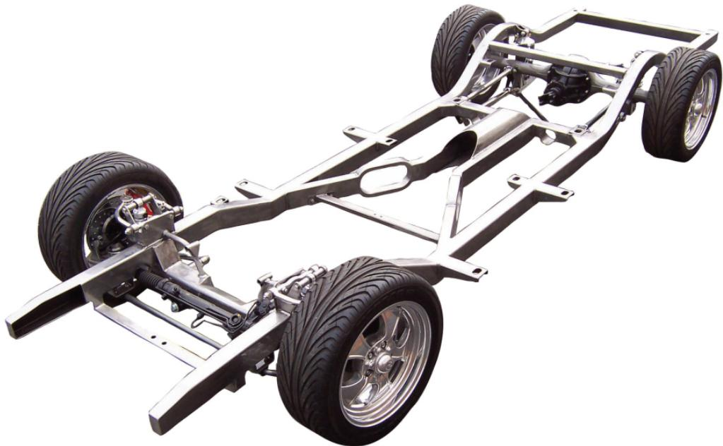
Slika 1. Klasični okvir motornog vozila [2]
