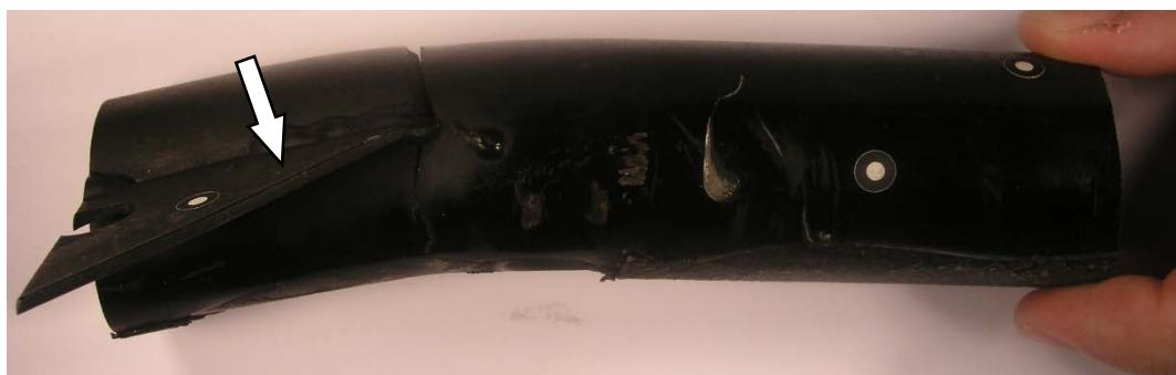
Slika 8. Plastična deformacija uzorka
