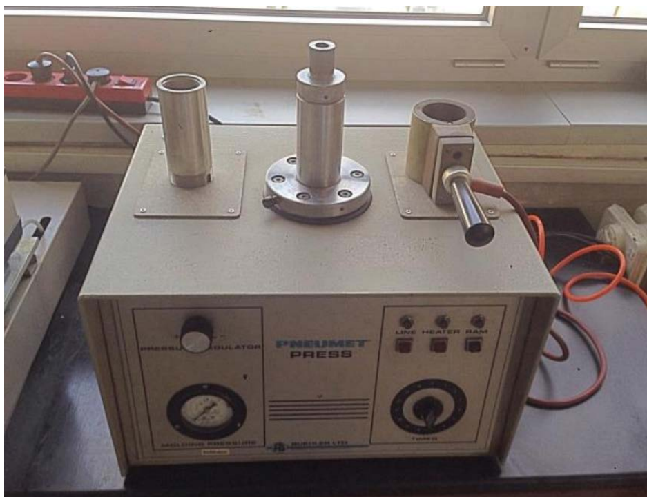
Slika 27. Uređaj za ulijevanje uzorka u polimernoj masi (topli postupak)
