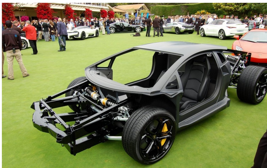
Slika 5. Podsklop okvir kod sportskog automobila Lamborghini Aventador [7]
