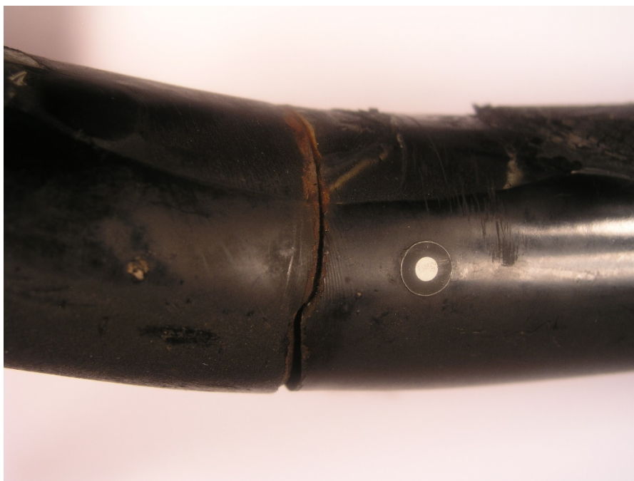
Slika 11. Pukotina na uzorku
