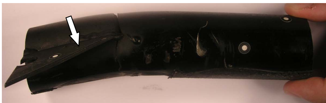
Slika 8. Plastična deformacija uzorka
