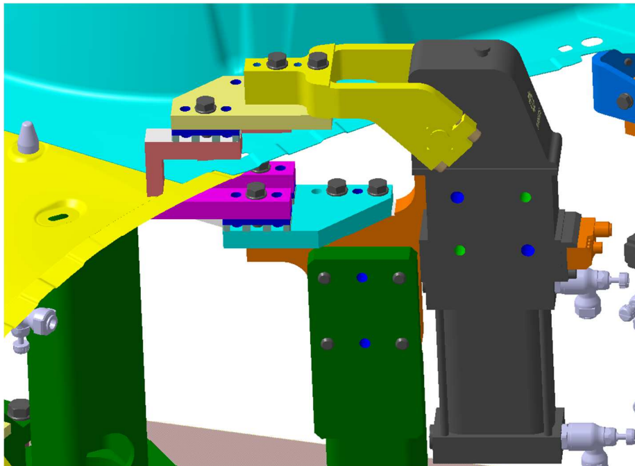
Slika 17. Prikaz automatske stege u fazi konstruiranja stroja
