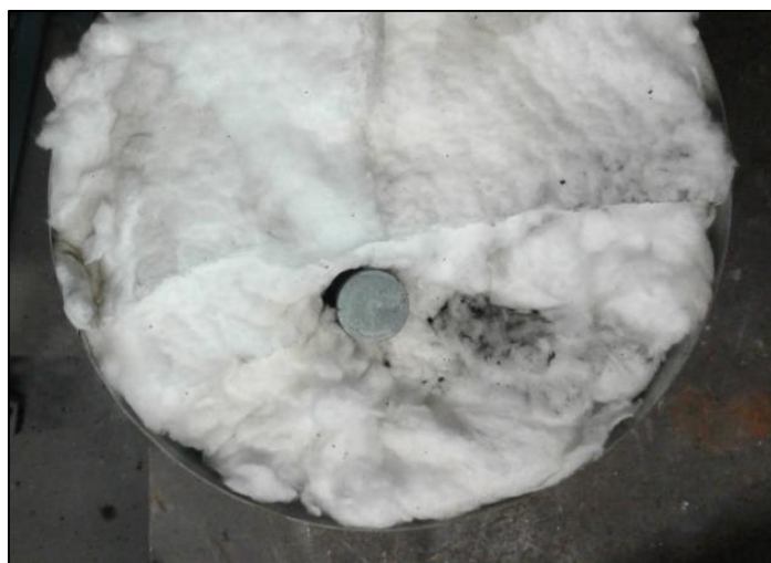
Slika 4.9 Ispitni uzorak ohlađen u izolaciji od aluminijsko silikatne izolacijske vune
