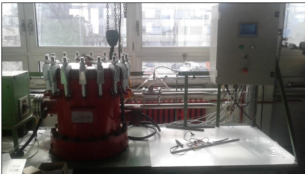
Slika 5.4 Aparatura za pokus čeonog gašenja nastrujavanjem stlačenog plina
