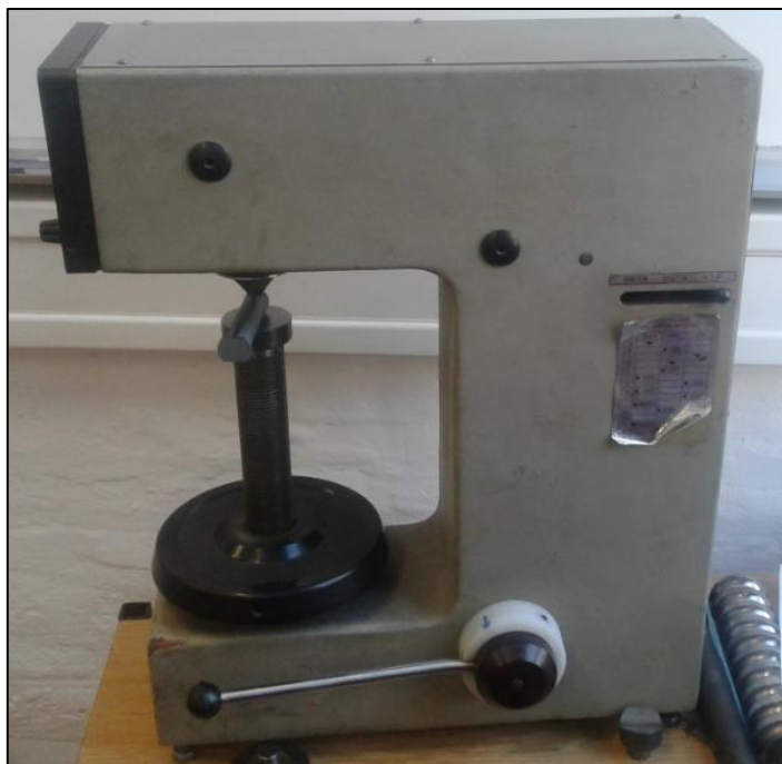
Slika 4.10 Tvrdomjer za ispitivanje po metodi Rockwell C
