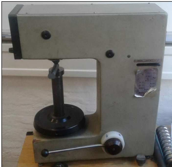
Slika 4.10 Tvrdomjer za ispitivanje po metodi Rockwell C
