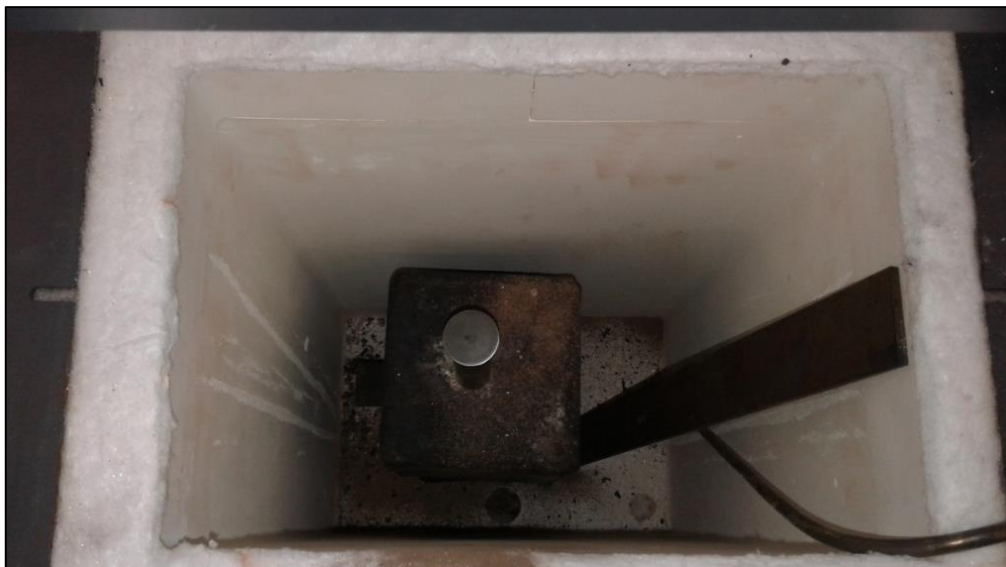
Slika 4.8 Ispitni uzorak na povišenom podiju unutar peći za toplinsku obradu
