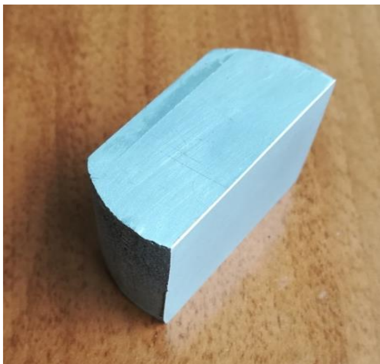
Slika 18. Aluminijski valjak iz kojega su izrezani uzorci druge skupine
