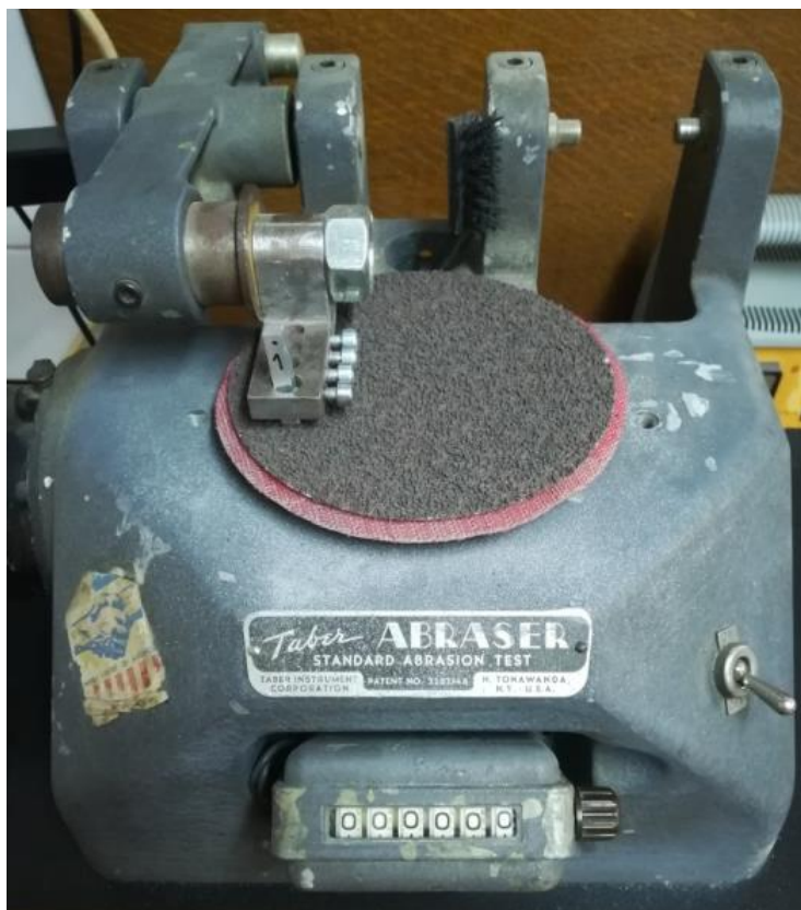
Slika 24. Uređaj za ispitivanje otpornosti na abrazijsko trošenje Taber abrader
