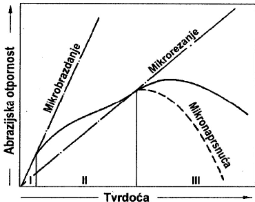
Slika 12. Ovisnost otpornosti abrazijskom trošenju o tvrdoći materijala [5]
