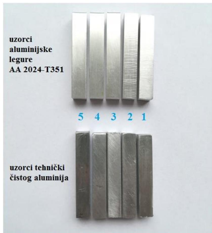
Slika 32. Uzorci nakon ispitivanja
