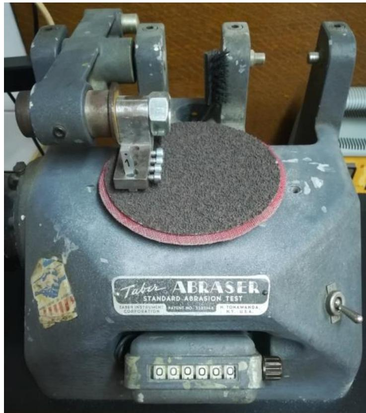
**Slika 24. Uredaj za ispitivanje otpornosti na abrazijsko trošenje *Taber abrader***
