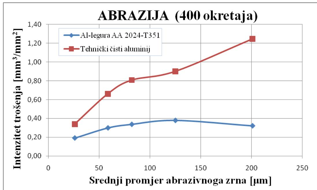
**Slika 36.** Intenzitet trošenja oba ispitivana materijala za različite srednje promjene abrazivnoga zrna
