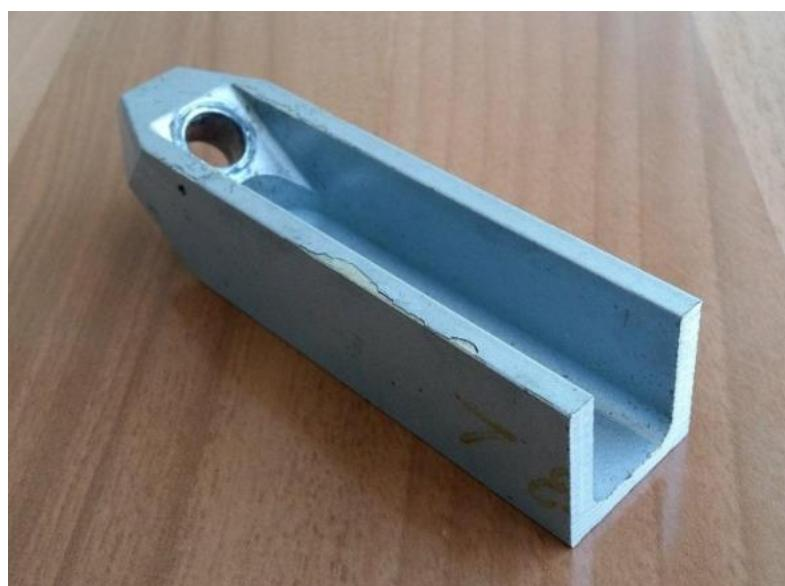
Slika 16. Dio stajnoga trapa zrakoplova
