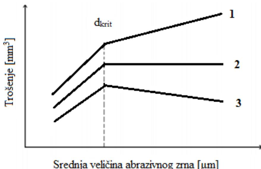
Slika 14. Utjecaj veličine abrazivnog zrna na abrazijsko trošenje materijala [7]
