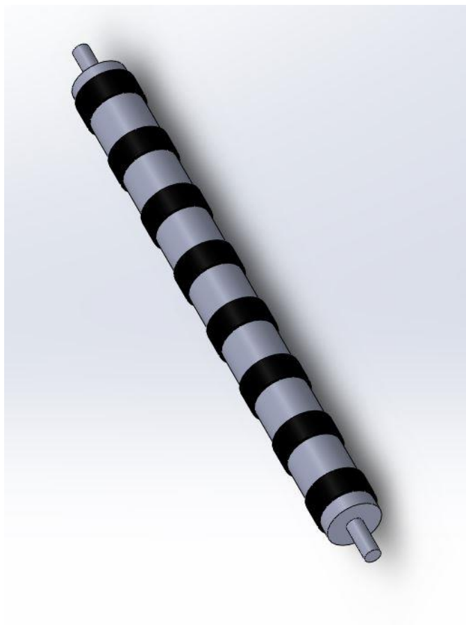
Slika 16. CAD model transportnog valjka
