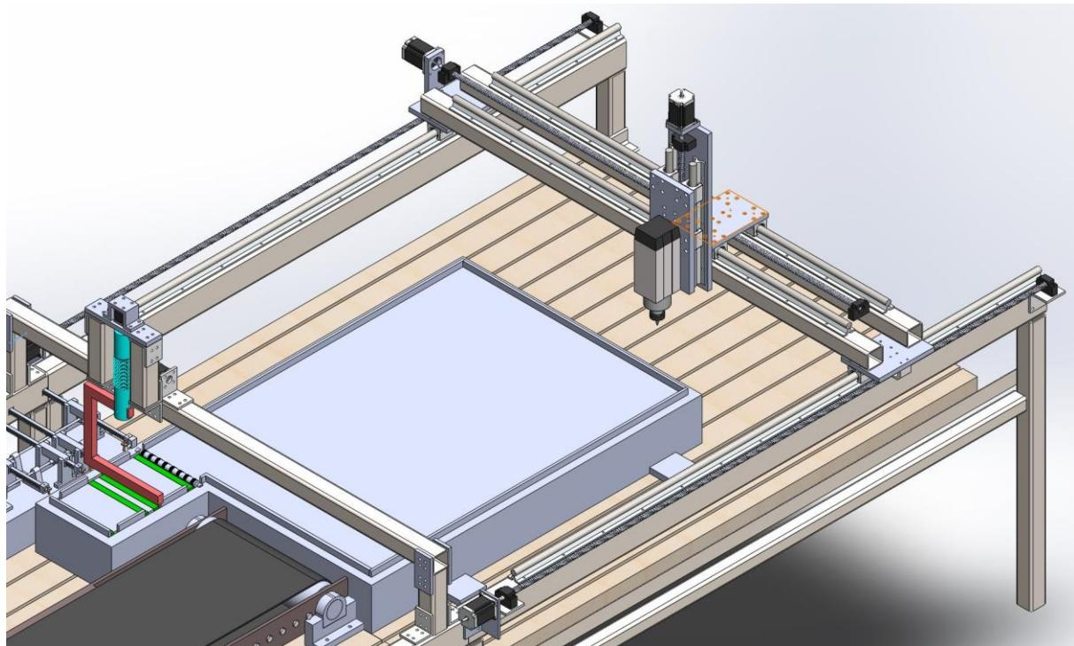
Slika 12. CAD model sustava za rezanje plastičnih traka
