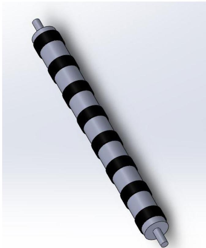
**Slika 16. CAD model transportnog valjka**
