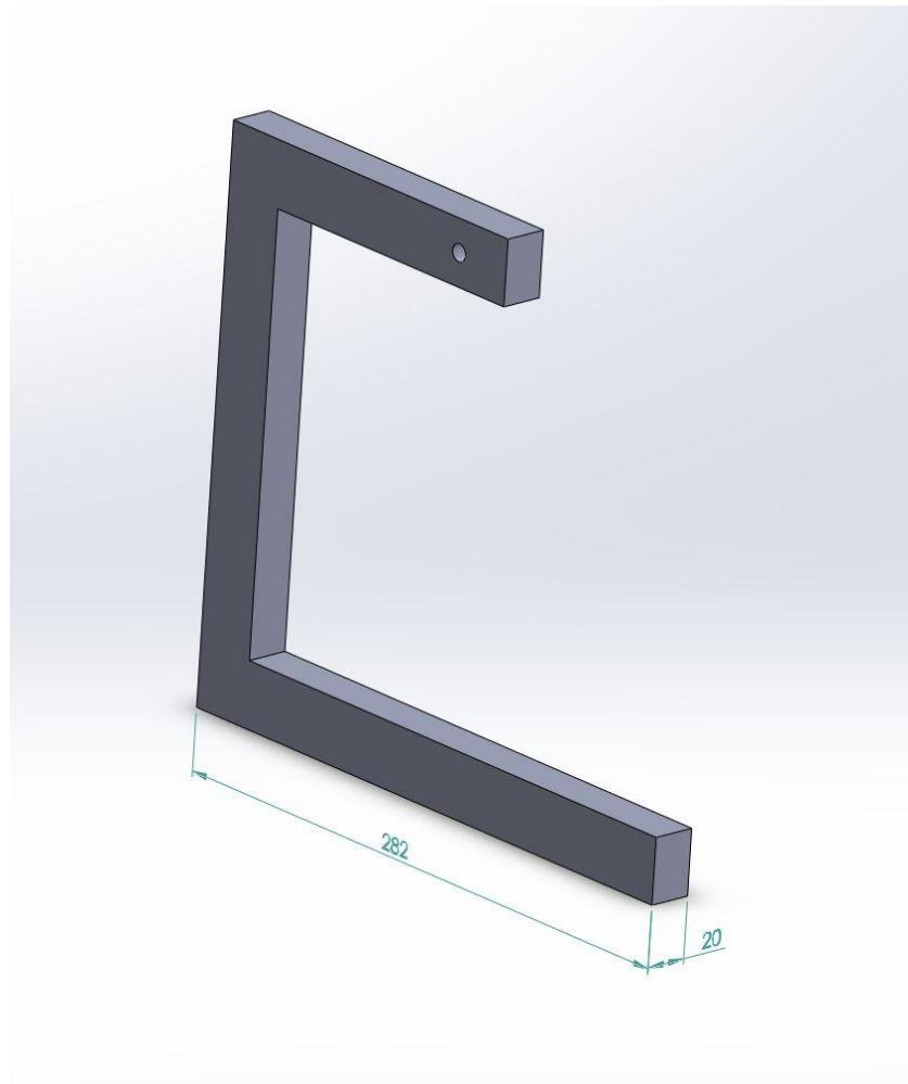
**Slika 21. CAD model alata za savijanje**
