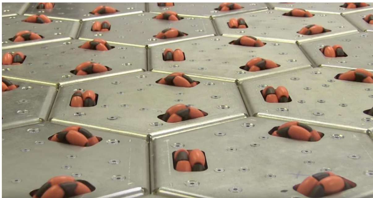
Slika 14. Modularni kotačići tvrtke Celluveyor [6]
