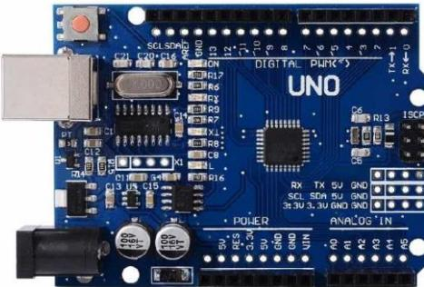
Slika 11. Primjer mikrokontrolera - Arduino UNO [4]
