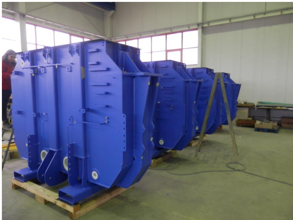
Slika 14. Kućišta energetskih transformatora nakon nanošenja premaza
