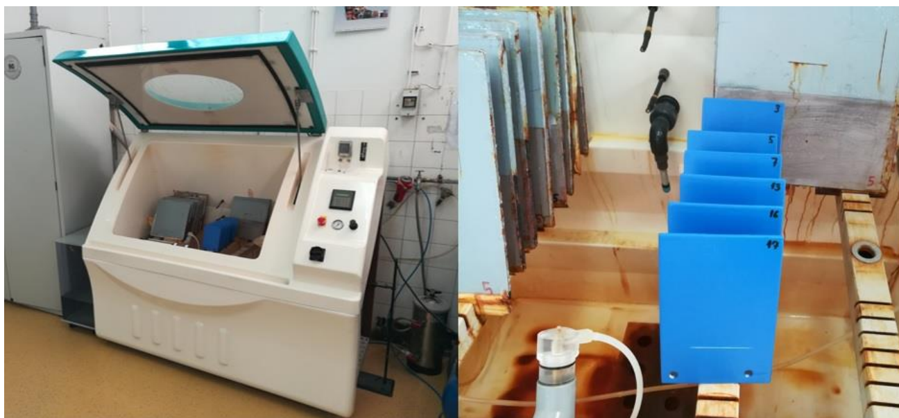
Slika 25. Ispitivanje u slanoj komori
