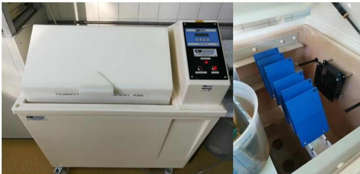
Slika 22. Uzorci u vlažnoj komori tipa Humidity cabinet model AB6
