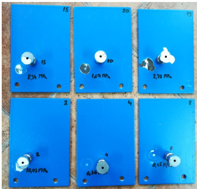
Slika 21. Rezultati mjerenja nakon vađenja uzoraka iz slane komore
