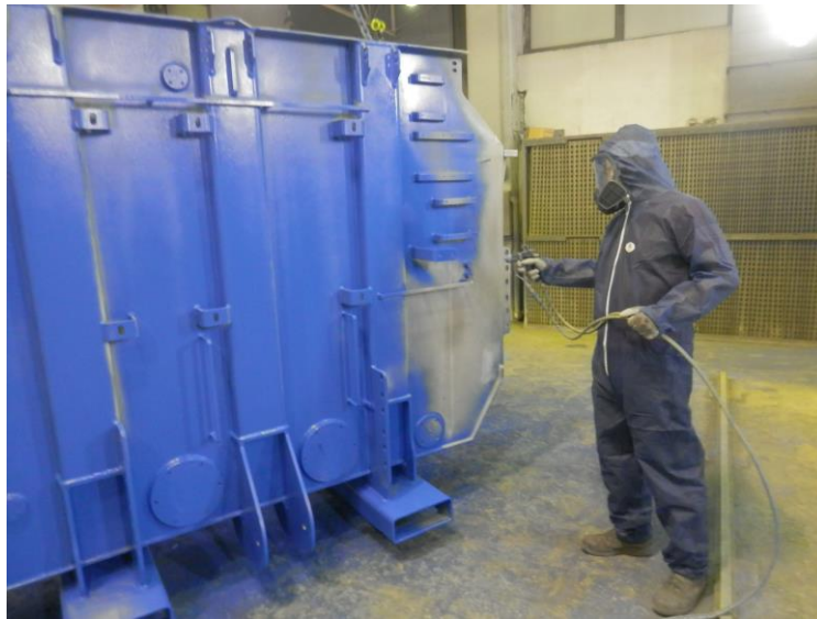
Slika 13. Nanošenje završnog premaza zračnim prskanjem
