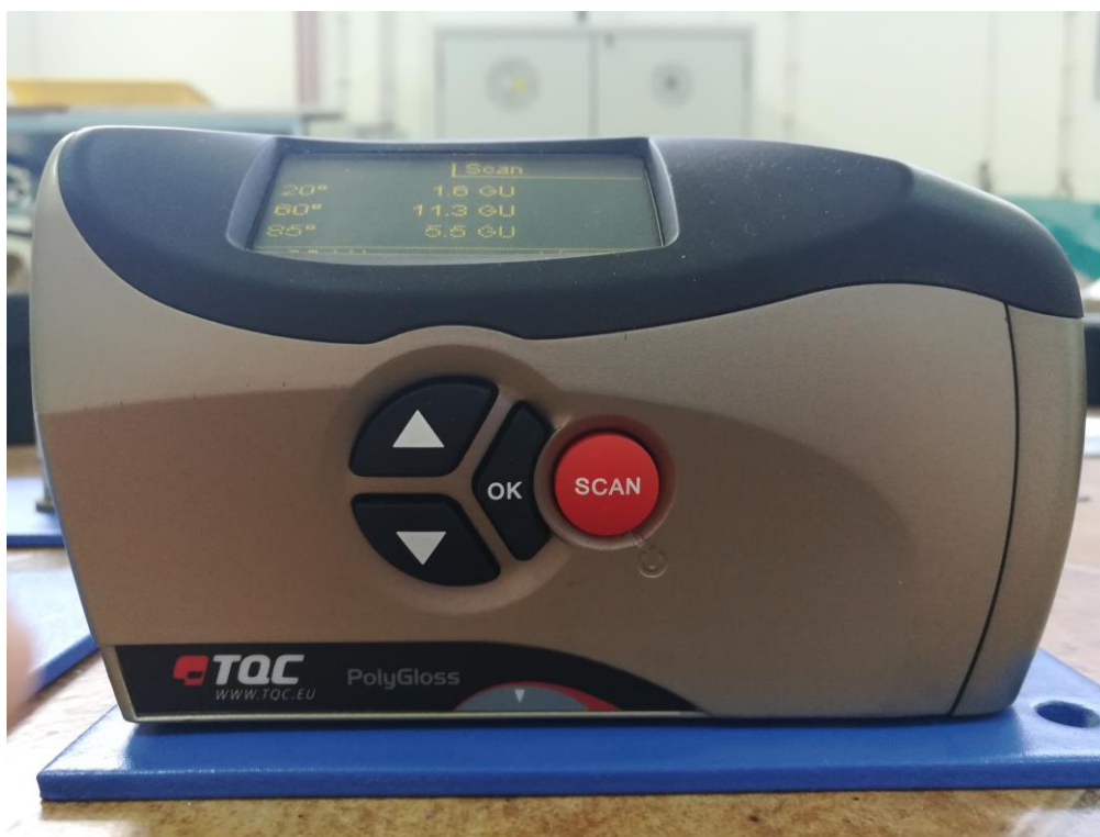
Slika 28. Mjerenje sjaja površine premaza
