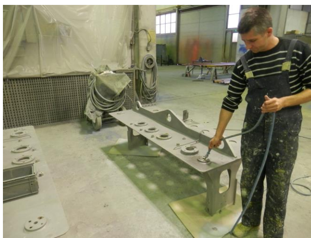
Slika 11. Čišćenje površina kućišta stlačenim zrakom
