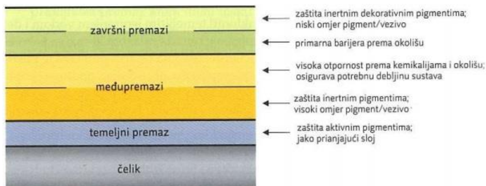
Slika 9. Sustav premaza debljine najčešće od 360 do 600 \mu\text{m} [5]
