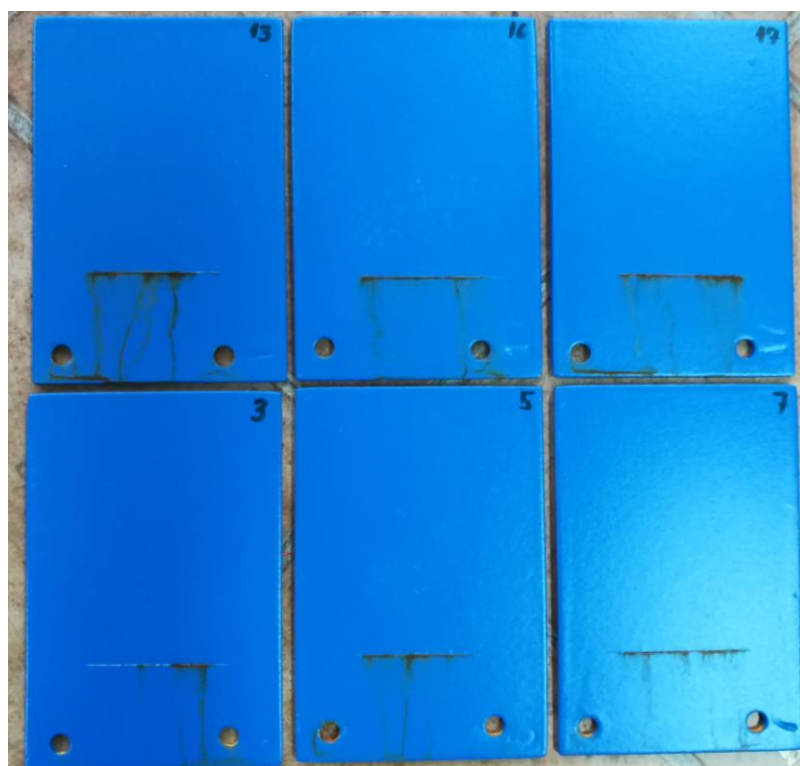
Slika 27. Uzorci nakon 720 h u slanoj komori
