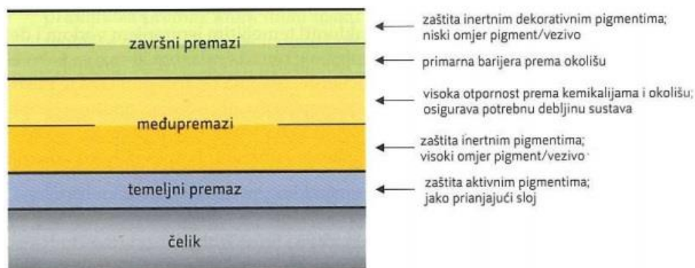
Slika 9. Sustav premaza debljine najčešće od 360 do 600 \mu\text{m} [5]
