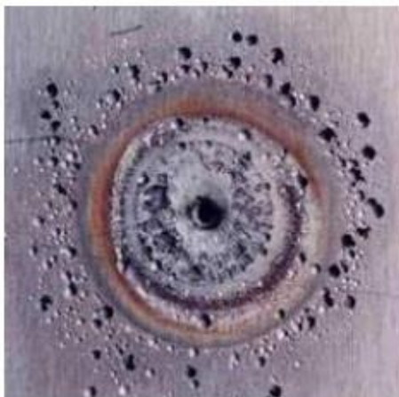
Slika 4. Primjer rupičaste korozije [7]
