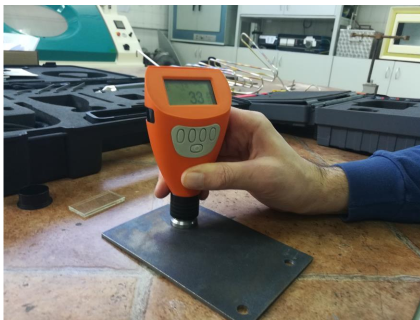
Slika 17. Postupak mjerenja hrapavosti na uzorku 11
