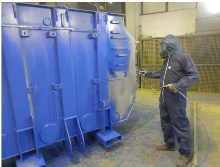
Slika 13. Nanošenje završnog premaza zračnim prskanjem
