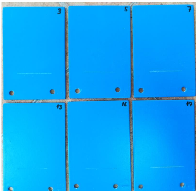
Slika 26. Uzorci prije stavljanja u slanu komoru
