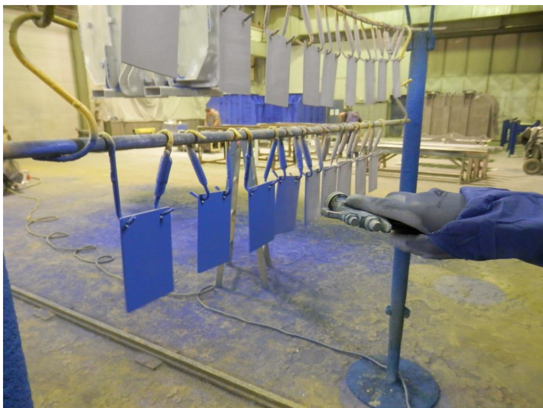
Slika 15. Nanošenje završnog premaza na uzorke, Midi d.o.o.
