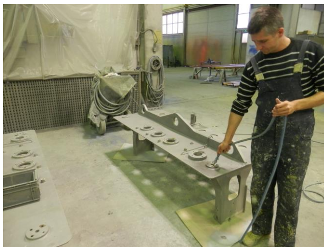
Slika 11. Čišćenje površina kućišta stlačenim zrakom
