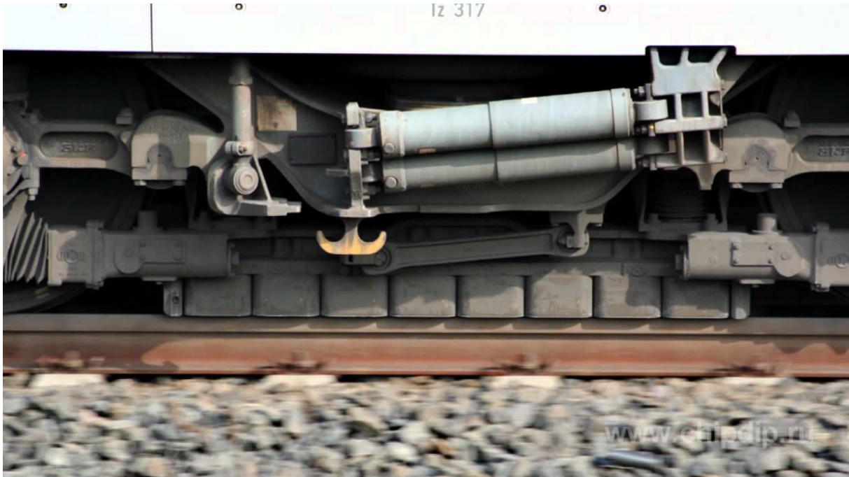
Slika 5. Elektromagnetna tračnička kočnica s niskim ovjesom
