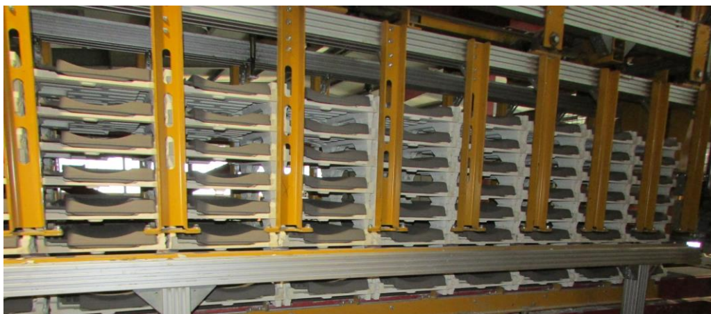
Slika 13. Crjepovi složeni u H-kasete prije pečenja
