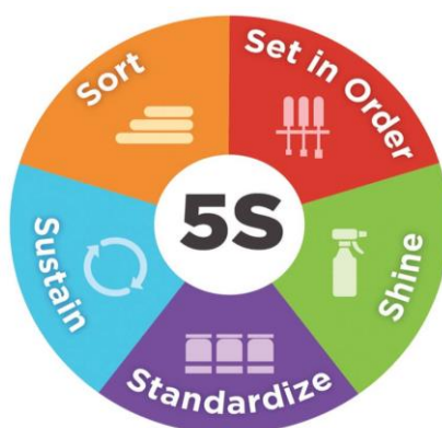
Slika 27. Shematski prikaz metode 5S [8]
