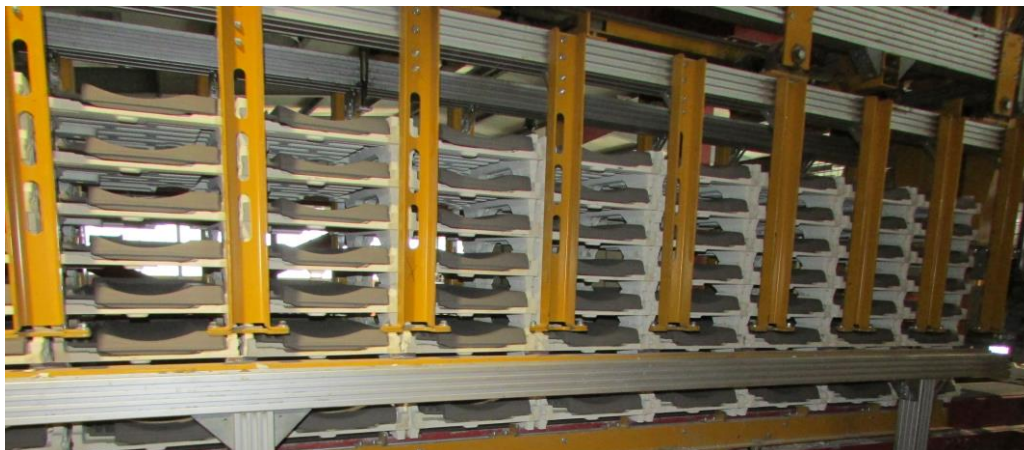
Slika 13. Crjepovi složeni u H-kasete prije pečenja
