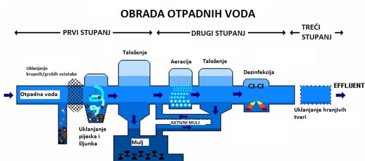
Slika 3.2 Shema procesa obrade otpadnih voda [7]
