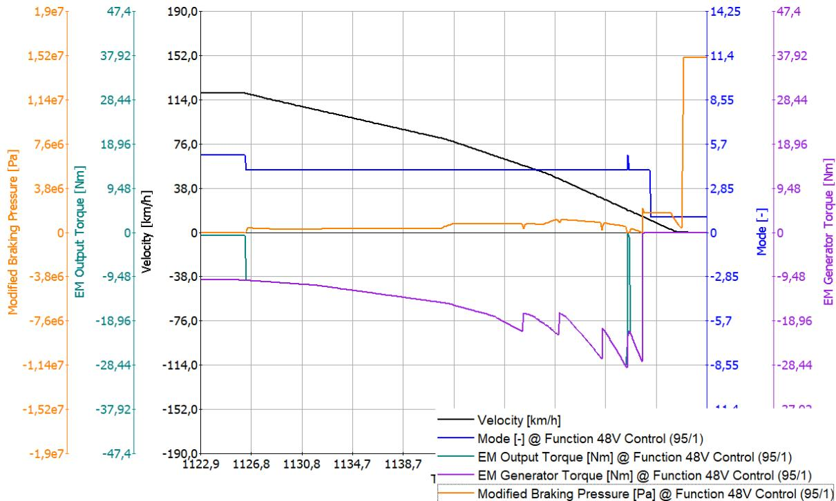
**Slika 5.10. Provjera funkciranja zajedničkog rada mehaničkih kočnica i regenerativnog kočenja**
