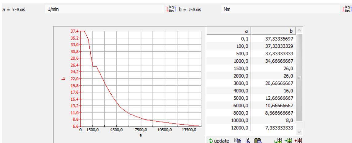
Slika 3.4. Maksimalni moment elektromotora u motornom načinu rada
