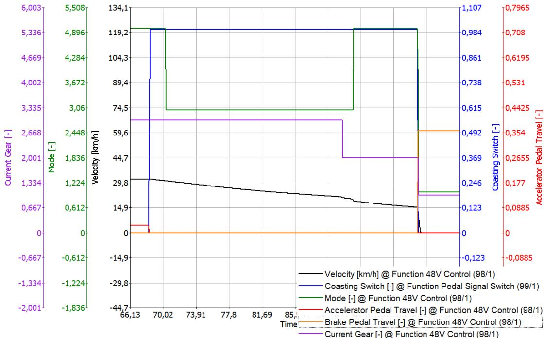
Slika 5.16. Provjera uvjeta za ulazak i izlazak iz funkcionalnosti pasivnog električnog krstarenja
