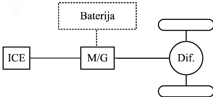
**Slika 2.4. Paralelna konfiguracija hibridnog pogona [4]**
