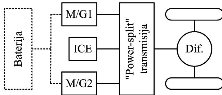
Slika 2.2. Serijsko – paralelna konfiguracija hibridnog pogona [4]
