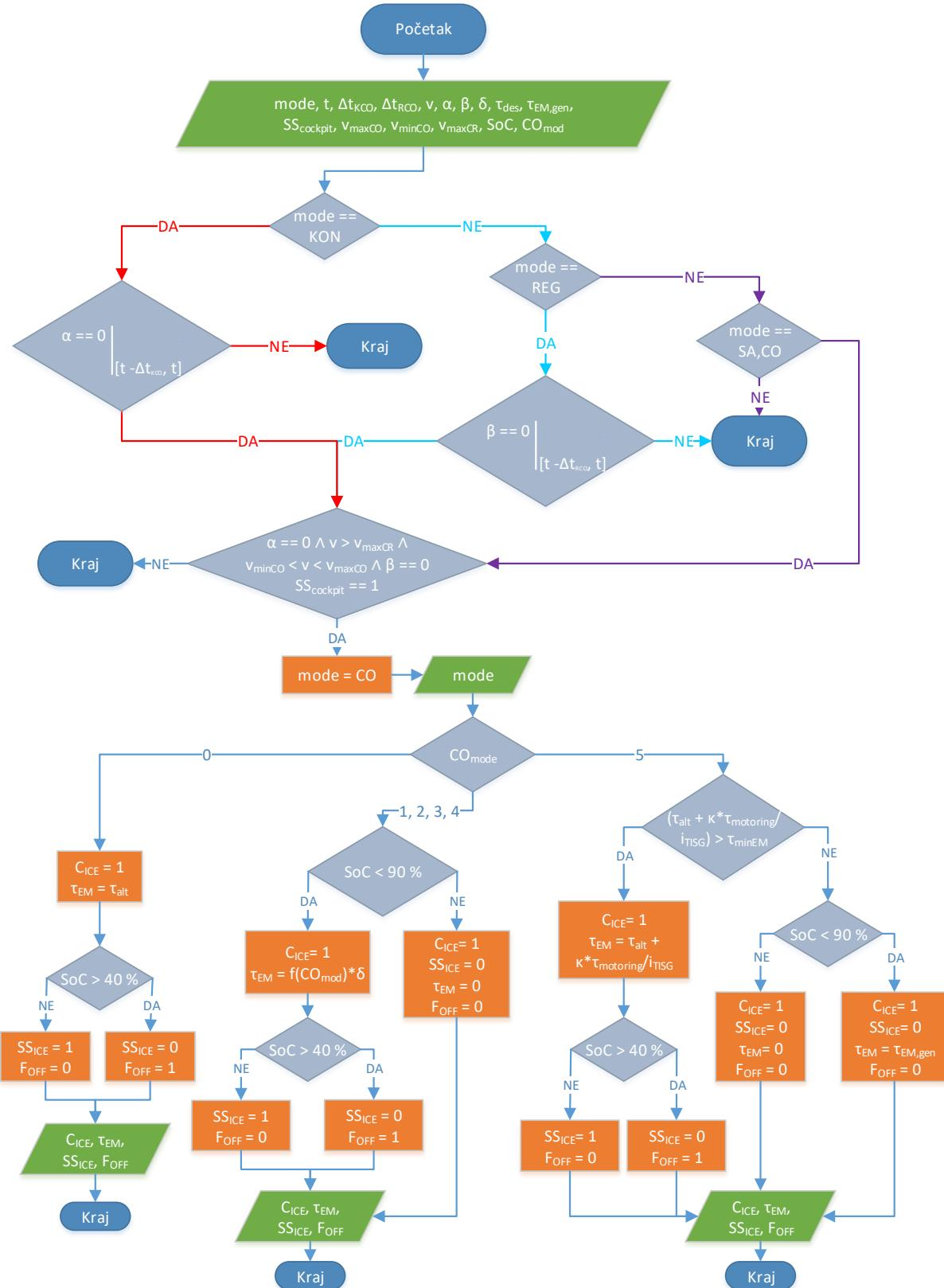
Slika 4.4. Dijagram toka funkcionalnosti pasivnog električnog krstarenja
