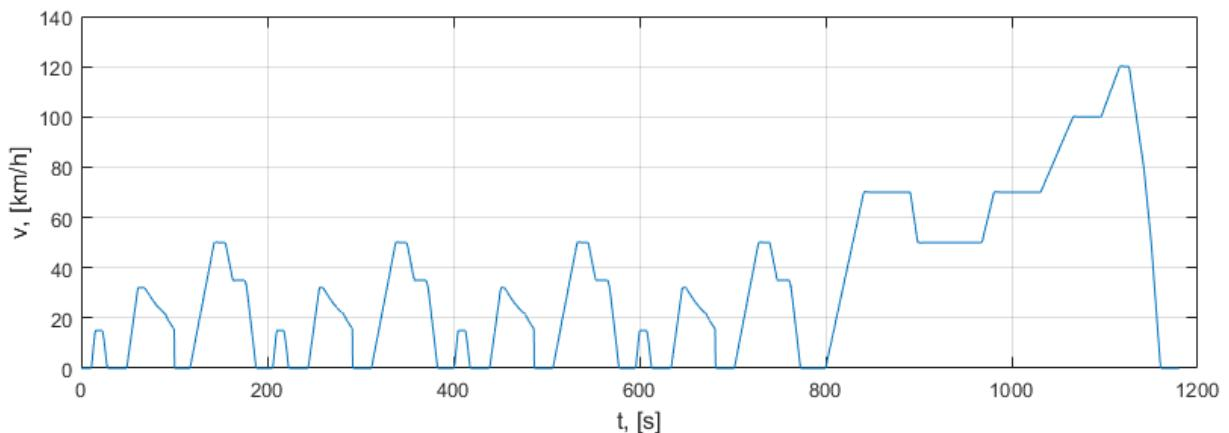
**Slika 5.5. Profil brzine modificiranog NEDC voznog ciklusa**
