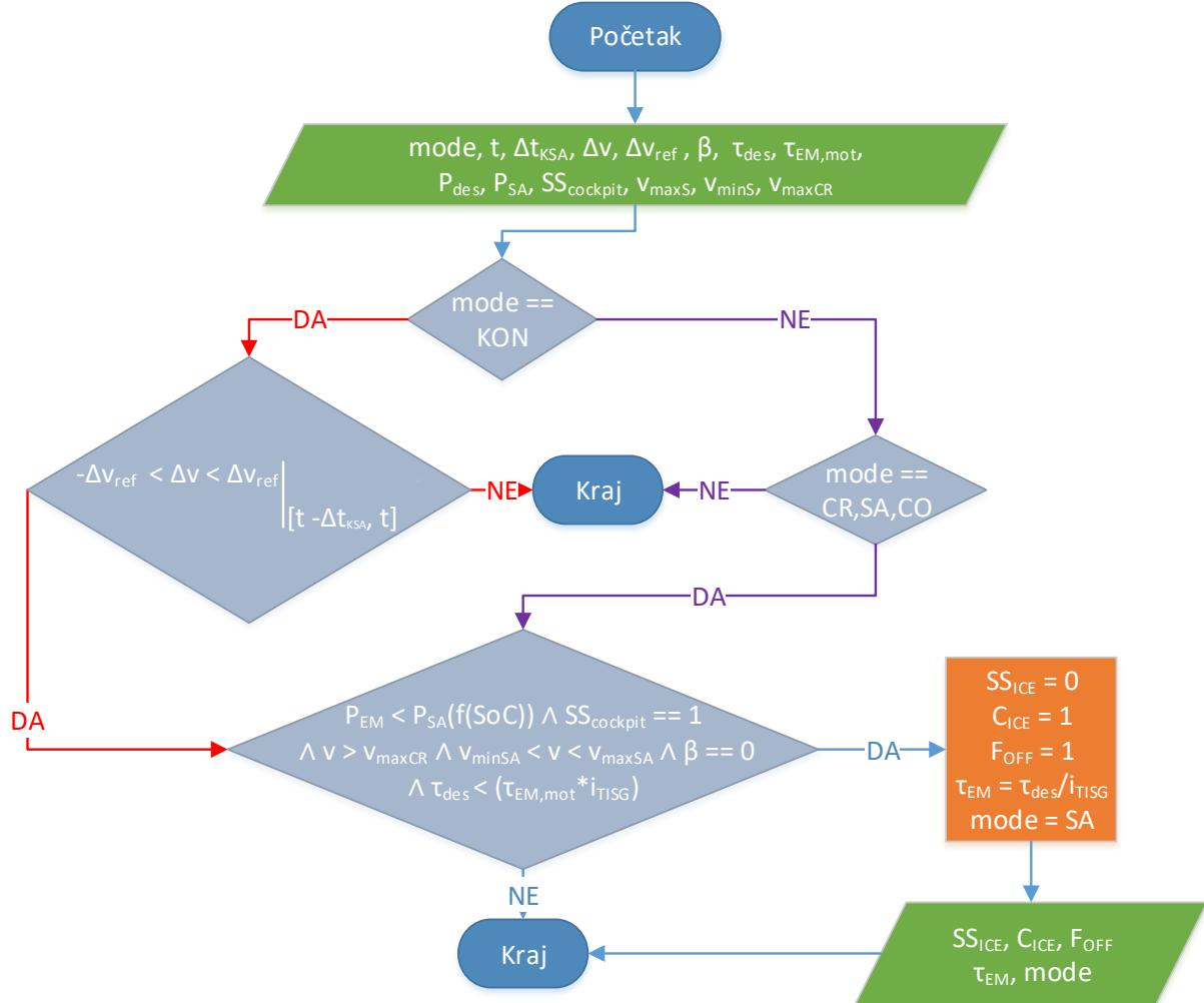
Slika 4.3. Dijagram toka funkcionalnosti aktivnog električnog krstarenja
