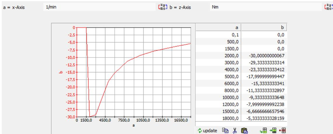
Slika 3.5. Maksimalni moment elektromotora u generatorskom načinu rada
