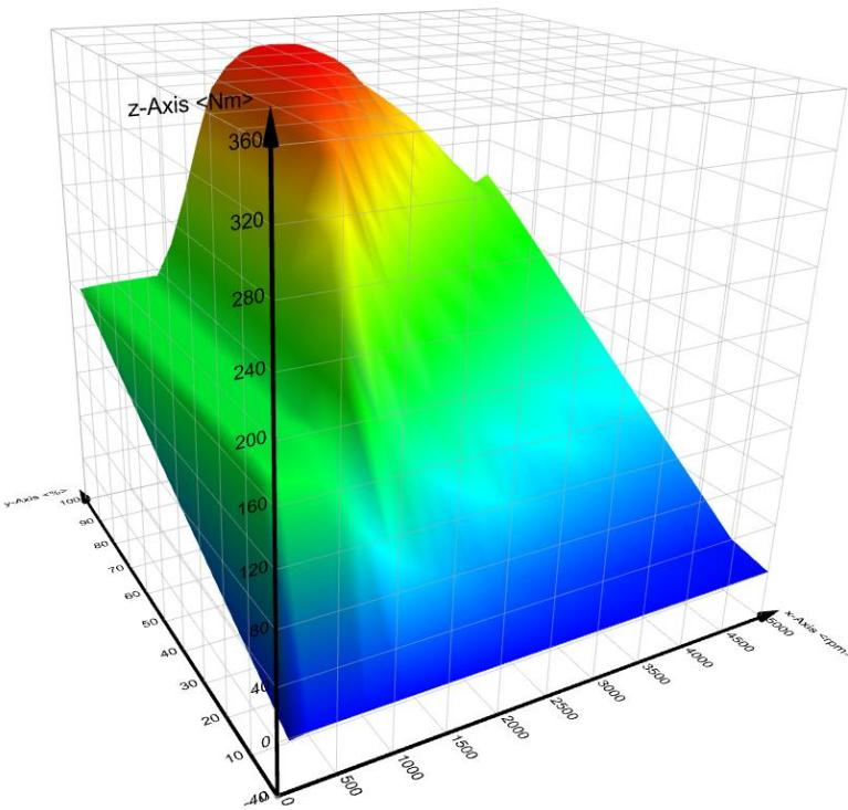
Slika 3.3. Željeni iznos momenta u ovisnosti o brzini vrtnje SUI motora i signalu papućice akceleratora
