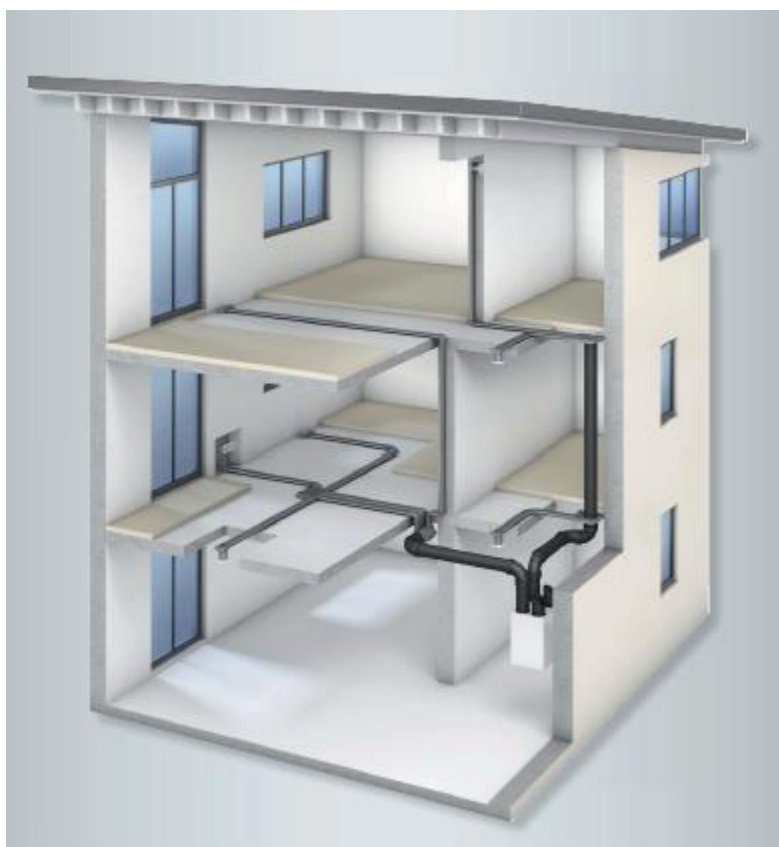
Slika 1.7 Centralni ventilacijski sustav
