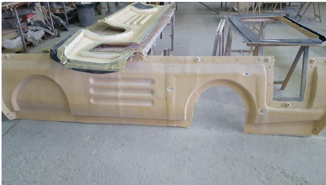
Slika 50. Kalup za izradu dijela karoserije vozila
