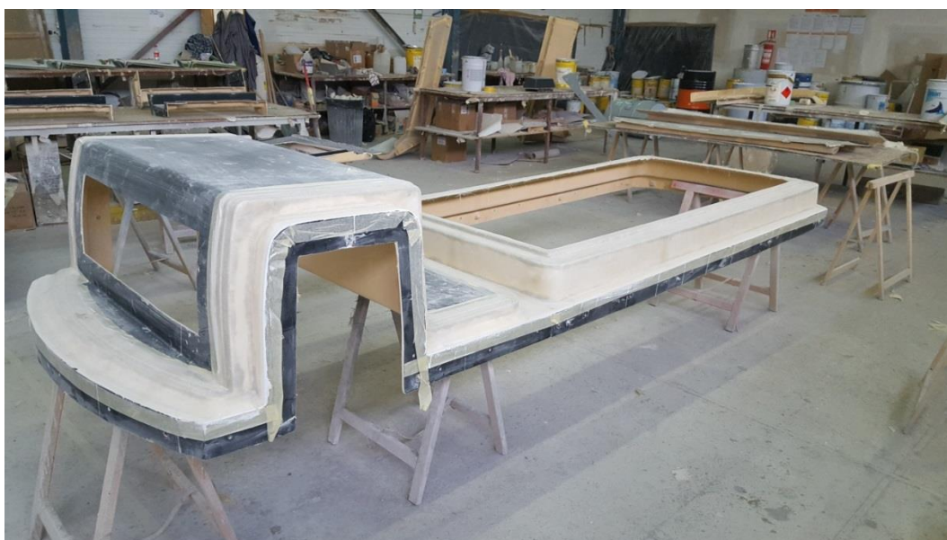
Slika 49. Kalup za izradu dijela karoserije vozila
