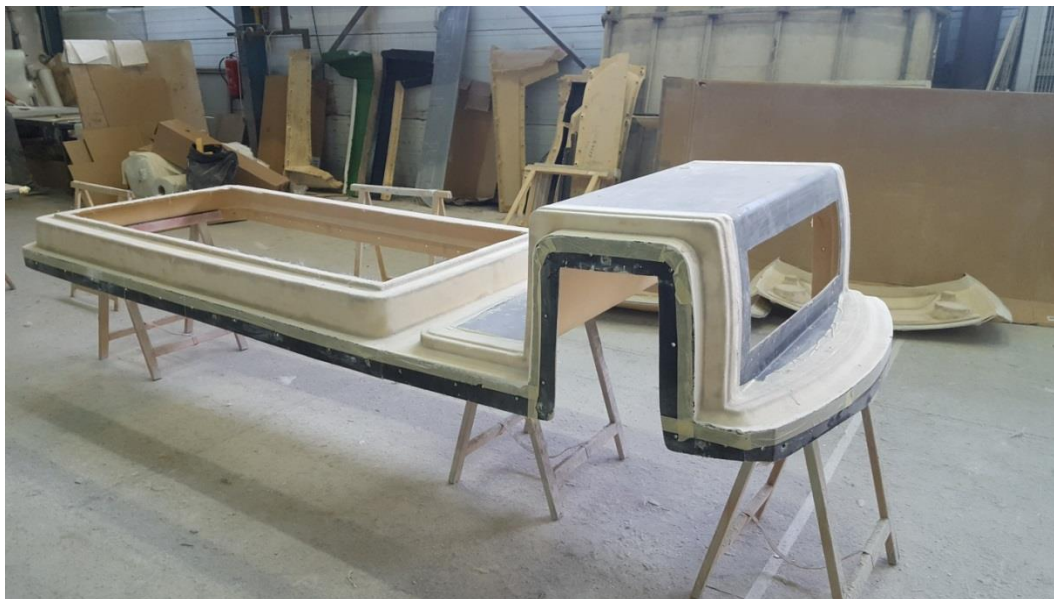
Slika 48. Kalup za izradu dijela karoserije vozila
