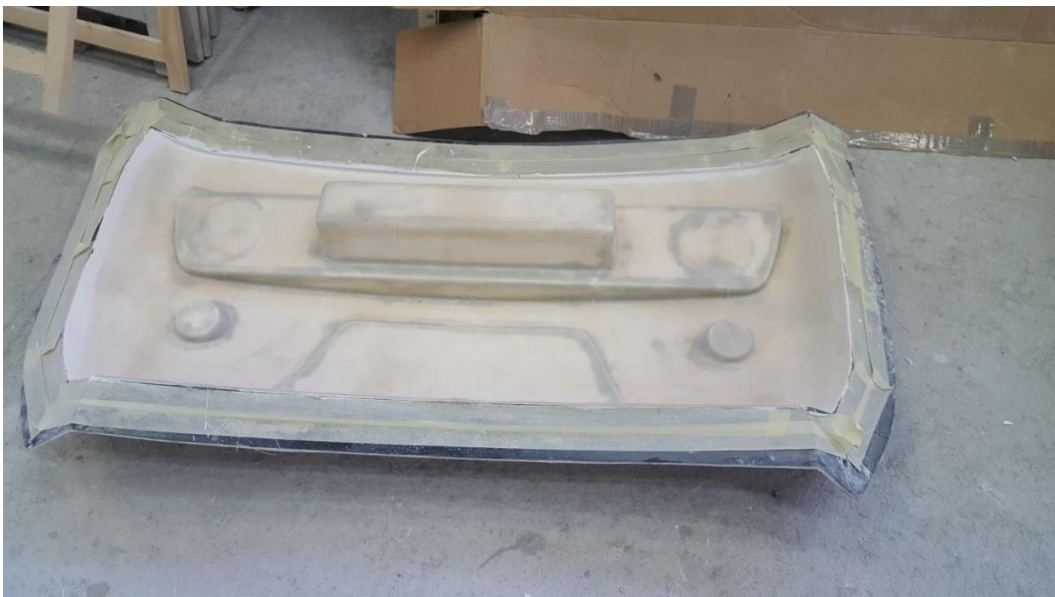
Slika 53. Kalup za izradu dijela karoserije vozila
