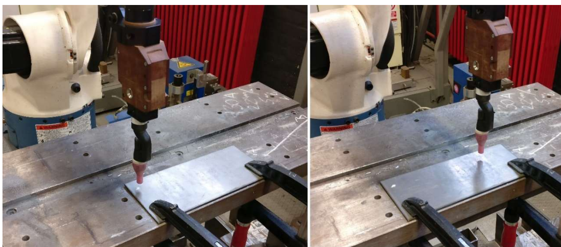
Slika 6.16 Početna (lijevo) i krajnja (desno) točka TIG postupka zavarivanja
