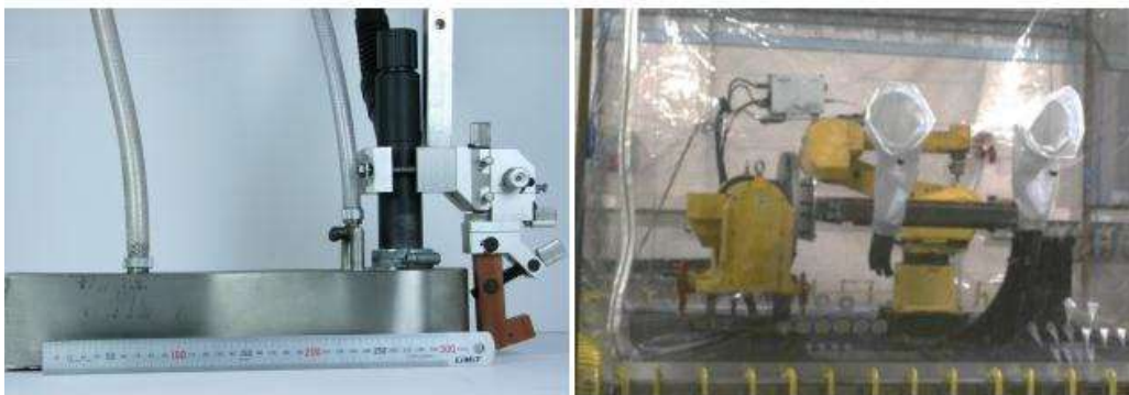
Slika 2.2 a) lokalni uređaj za zaštitu; b) zatvoreni šator u kojem se nalazi zaštitni plin [2]
