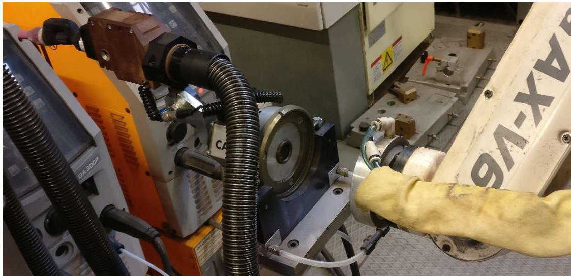
Slika 6.14 Prilaz TIG pištolja za zavarivanje
