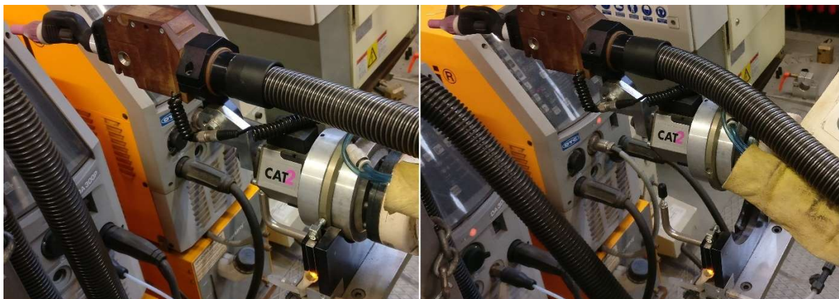
Slika 6.15 Prihvat TIG pištolja za zavarivanje
