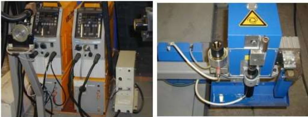
Slika 5.4 Izvori struje za zavarivanje sa ARC senzorom i sustav za čišćenje sapnice i rezanje žice. [20]
