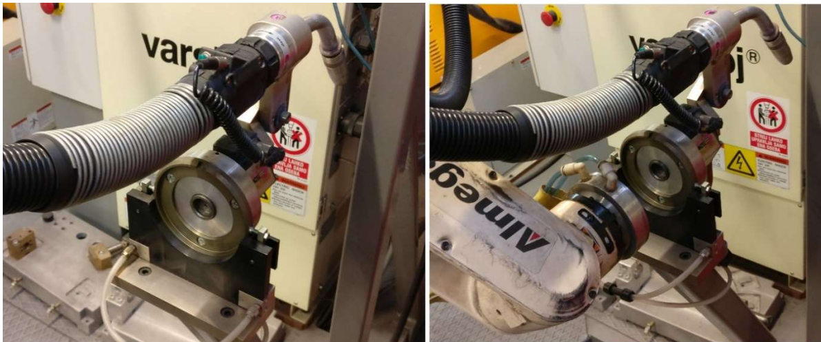
Slika 6.11 Prilaz nosaču MIG/MAG pištolja za zavarivanje
