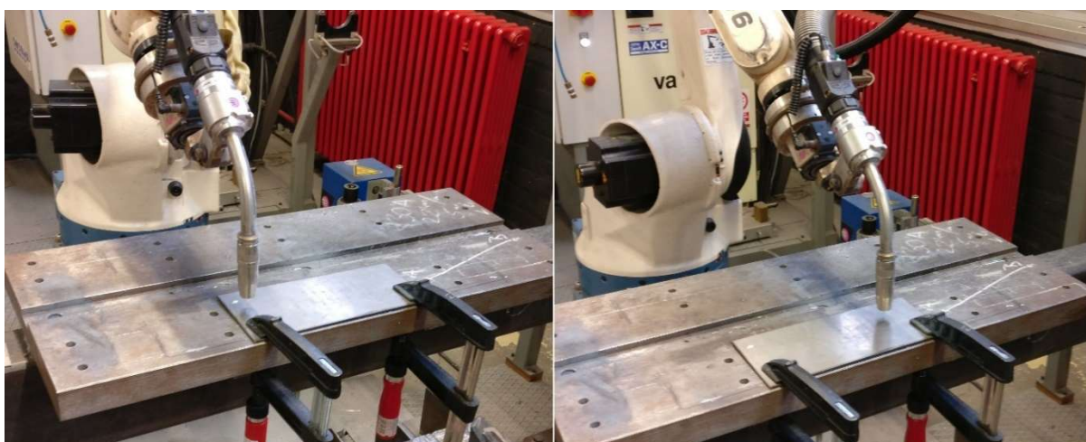
Slika 6.13 Početna (lijevo) i krajnja (desno) točka MIG/MAG postupka zavarivanja
