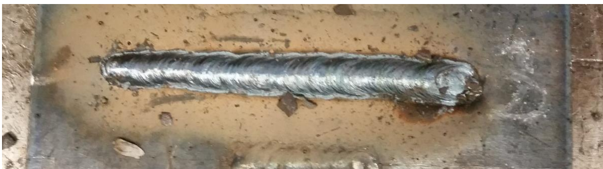
Slika 43. Zavar ispitnog uzorka 3 i ispitne ploče
