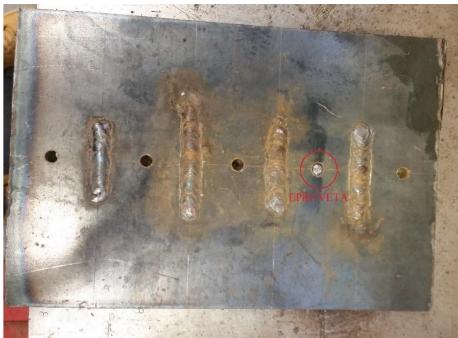
Slika 36. Pripremljena osnovna ploča s pozicioniranom epruvetom
