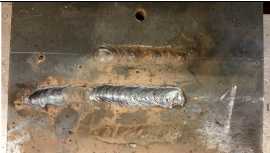
Slika 39. Zavar ispitnog uzorka 1 i ispitne ploče
