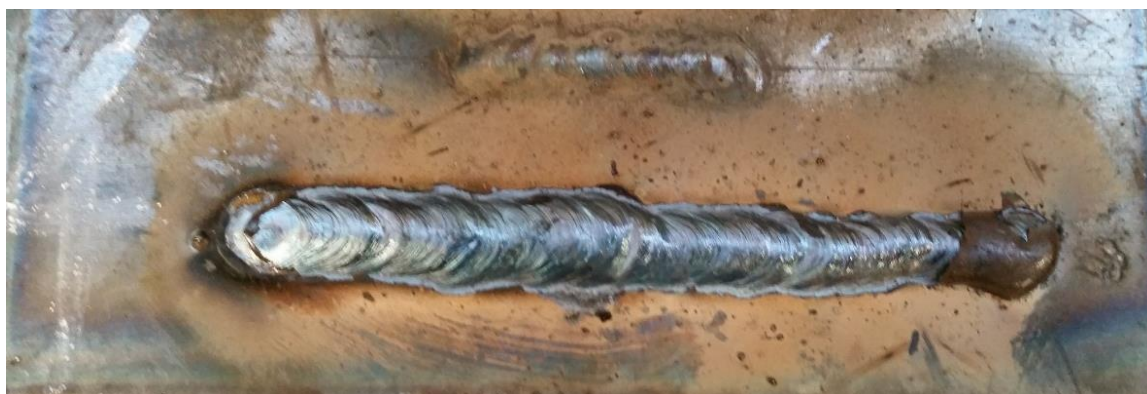
Slika 45. Zavar ispitnog uzorka broj 4 i ispitne ploče
