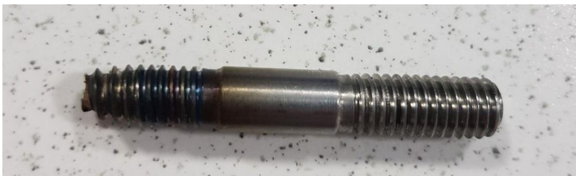
Slika 46. Ispitni uzorak broj 4 nakon loma
