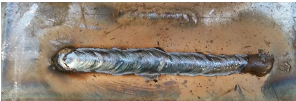
Slika 45. Zavar ispitnog uzorka broj 4 i ispitne ploče
