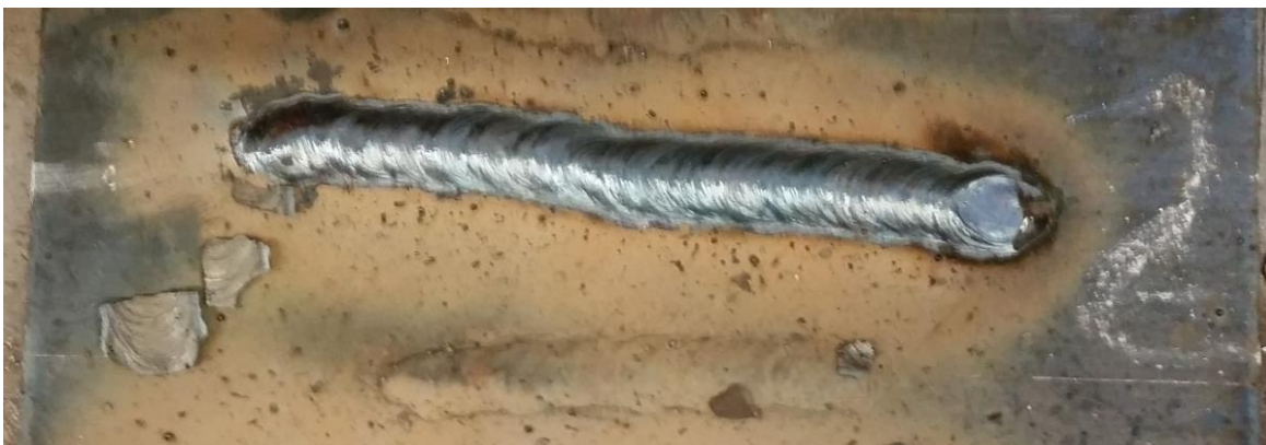
Slika 41. Zavar ispitnog uzorka 2 i ispitne ploče
