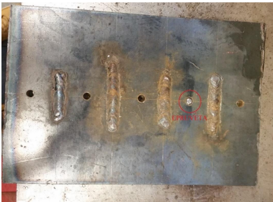
Slika 36. Pripremljena osnovna ploča s pozicioniranom epruvetom
