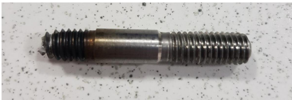
Slika 40. Ispitni uzorak 1 nakon loma
