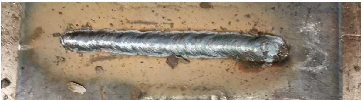
Slika 43. Zavar ispitnog uzorka 3 i ispitne ploče
