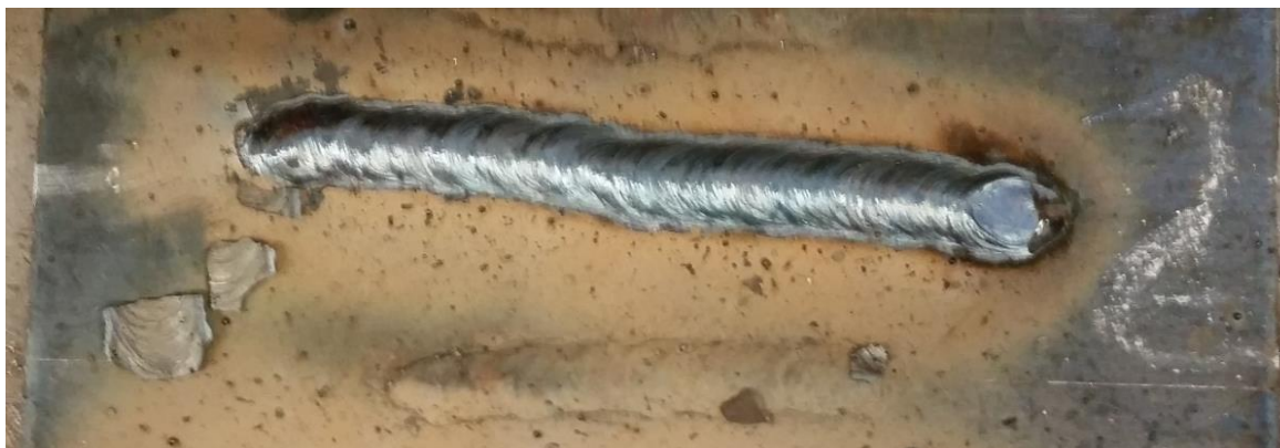
Slika 41. Zavar ispitnog uzorka 2 i ispitne ploče
