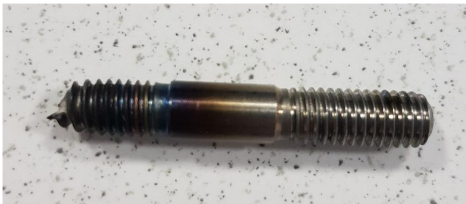
Slika 42. Ispitni uzorak broj 2 nakon loma
