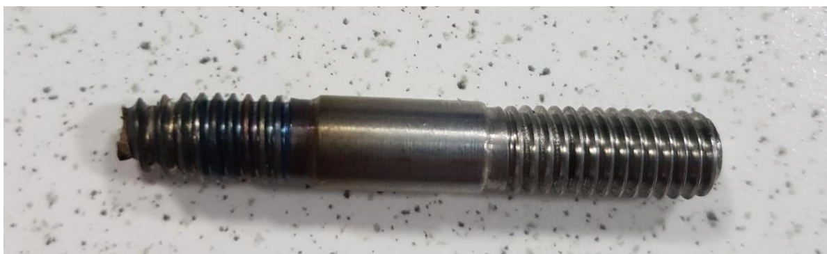
Slika 46. Ispitni uzorak broj 4 nakon loma
