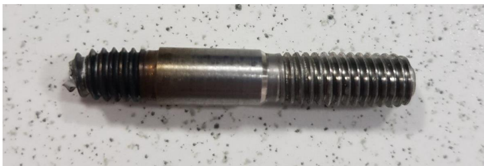
Slika 40. Ispitni uzorak 1 nakon loma
