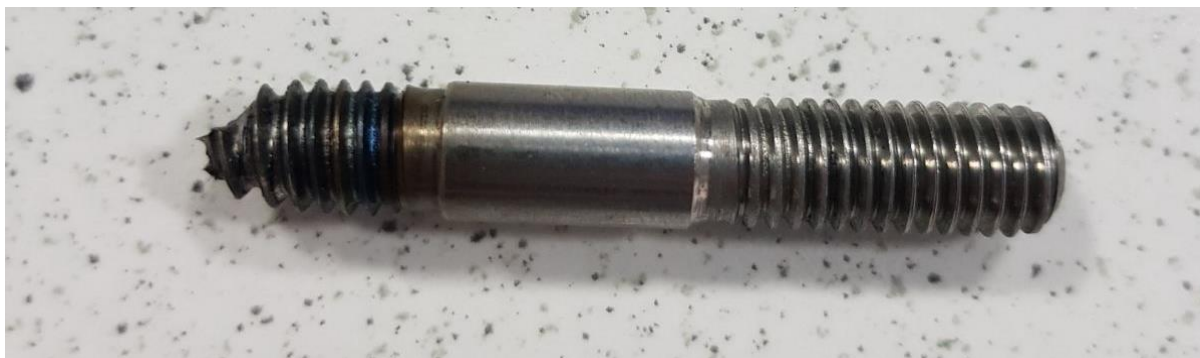
Slika 44. Ispitni uzorak broj 3 nakon loma
