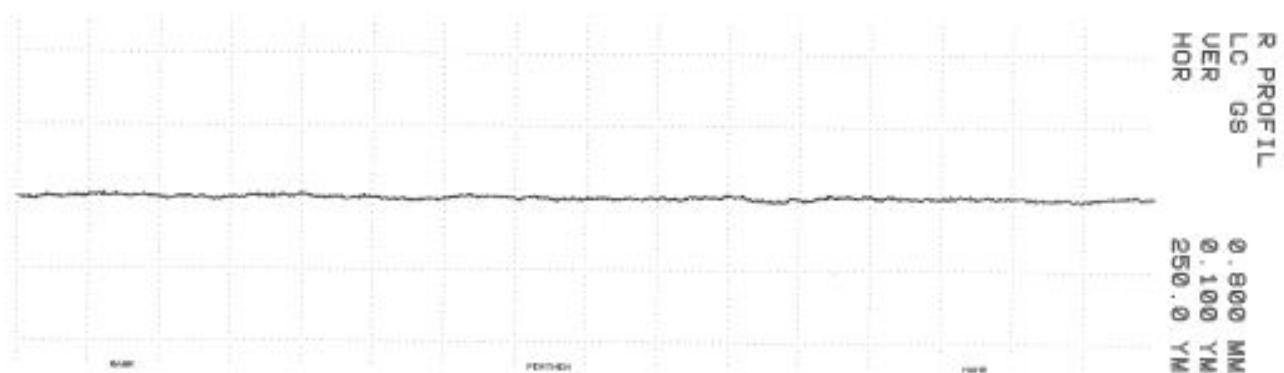
Slika 25. Rezultat mjerena hrapavosti površine wafera
