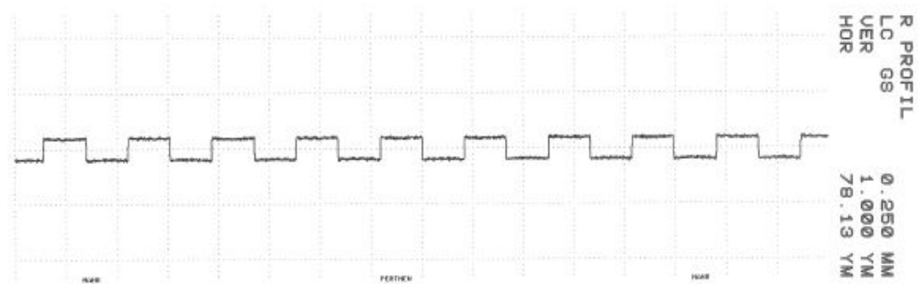
Slika 41. Izgled simuliranog pravokutnog profila  $Rz = 0,4 \mu\text{m}$
