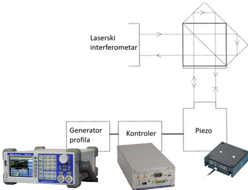
Slika 23. Shema umjeravanja piezo pretvornika pomaka
