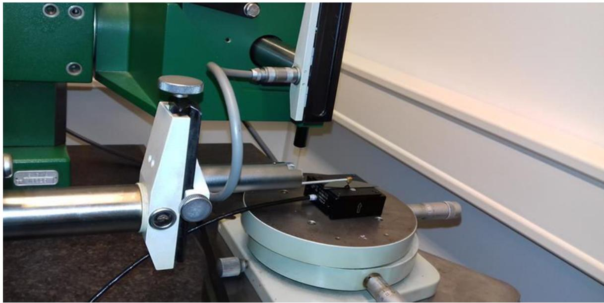
Slika 45. Izgled mjernog uređaja pri umjeravanju vertikalne komponente
