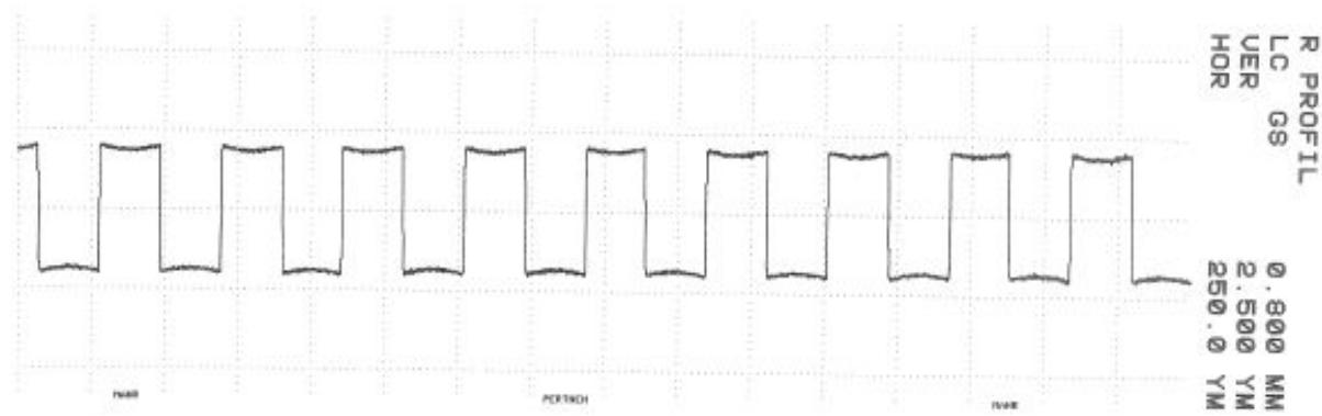
Slika 42. Prikaz simuliranog pravokutnog profila  $R_z = 4 \mu\text{m}$
