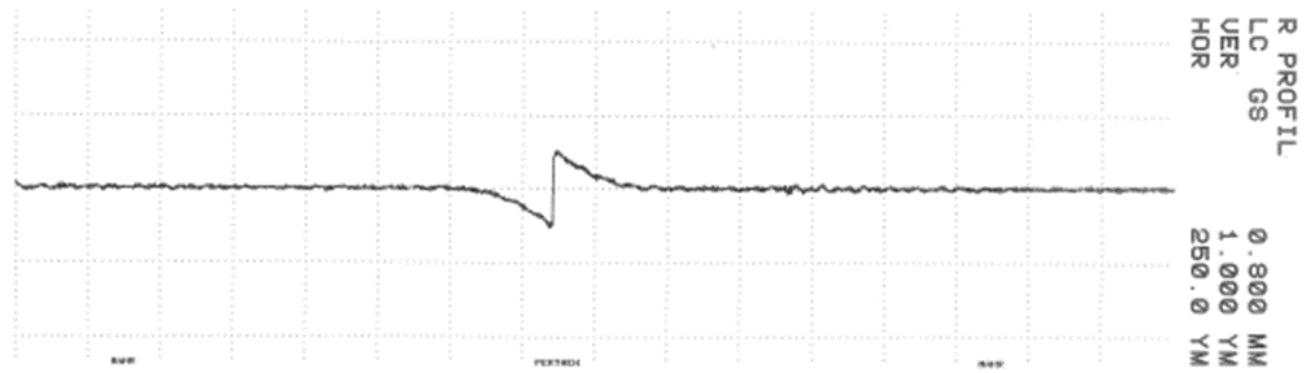
Slika 48. Simulirani profil  $P_t = 1 \mu\text{m}$
