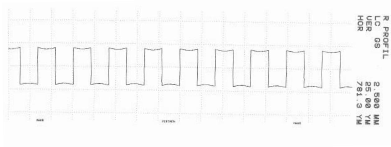
Slika 43. Prikaz pravokutnog simuliranog profila  $R_z = 40 \mu\text{m}$
