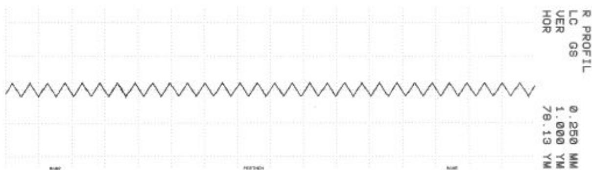
Slika 34. Prikaz simuliranog profila nazivne vrijednosti  $Rz = 0,4 \mu\text{m}$
