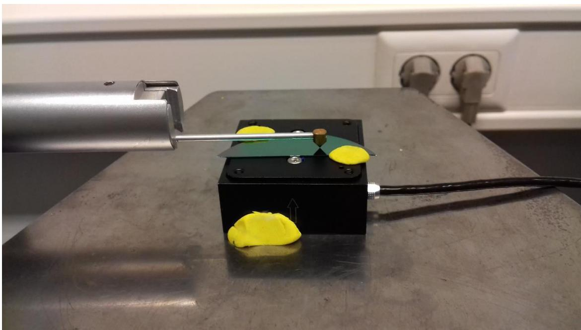
Slika 31. Prikaz ticala pomoću kojeg se provodilo umjeravanje
