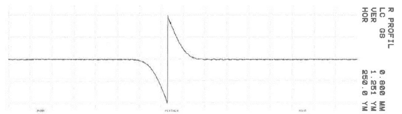
Slika 49. Simulirani profil  $P_t = 5 \mu\text{m}$
