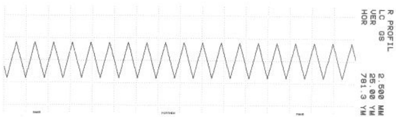
Slika 36. Prikaz simuliranog profila nazivne vrijednosti  $Rz = 40 \mu\text{m}$
