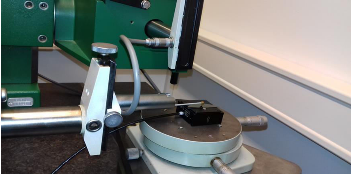
Slika 45. Izgled mjernog uređaja pri umjeravanju vertikalne komponente
