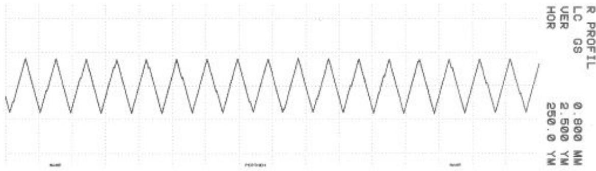
Slika 35. Prikaz simuliranog profila nazivne vrijednosti  $Rz = 4 \mu\text{m}$
