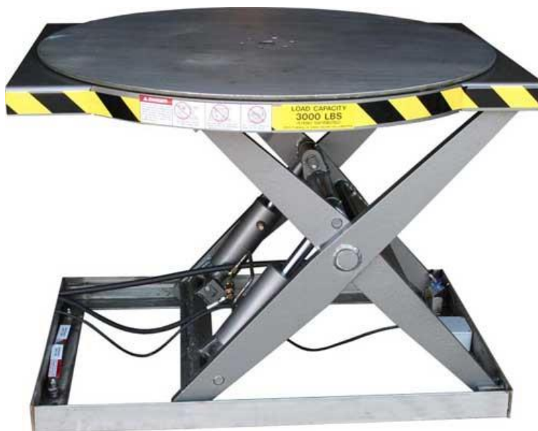
Slika 39. Primjer okretno-podiznog stola [16]
